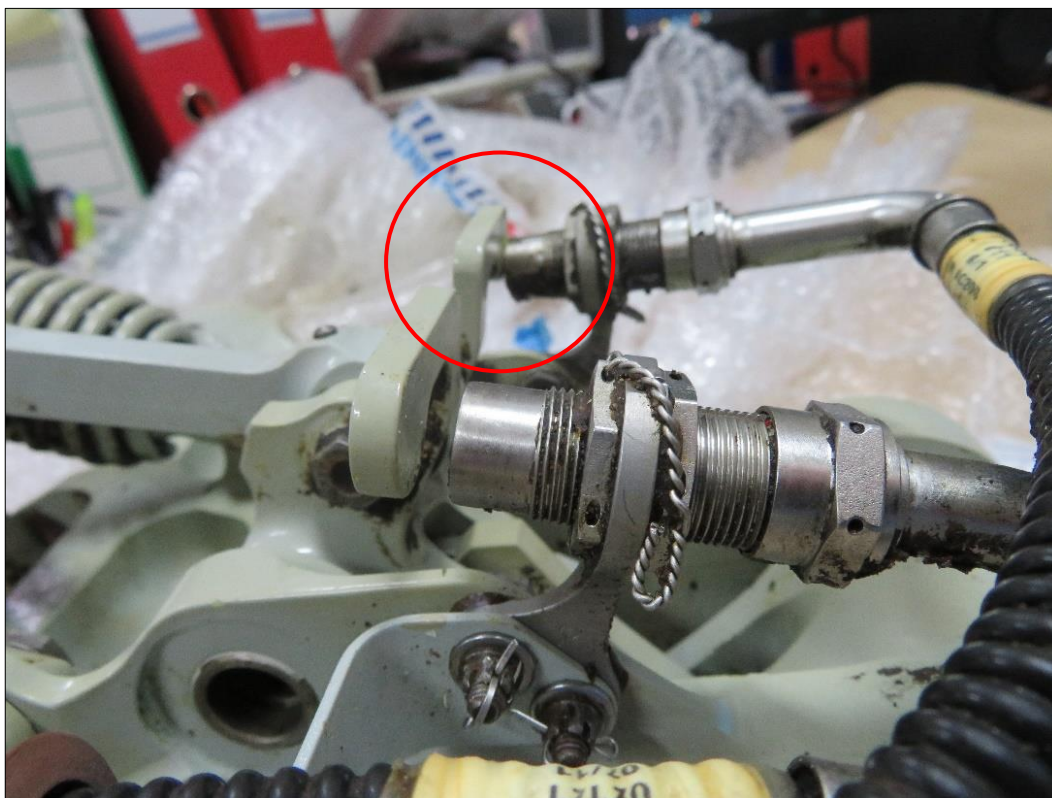
Rys. 6. Drag Strut Assembly – kółkiem czerwonym zaznaczono kolizję czujnika zbliżeniowego (Proximity Sensor – NGLK2) z jego płaszczyzną detekcji.
