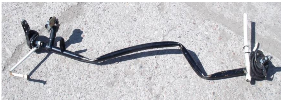
Rys. 15 – Element układu sterowania sterem wysokości
