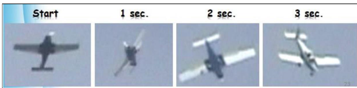
Rys. 18 – Przebieg próby wyprowadzania samolotu P2002-JF z korkociągu [z prospektu producenta].
