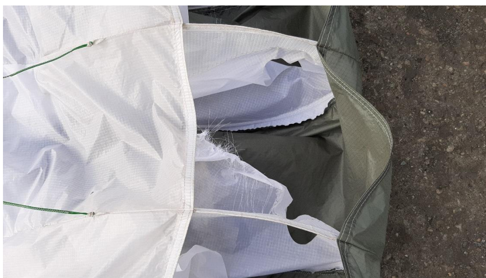
Rys. 4. Rozerwana struktura wewnętrzna skrzydła [źródło: PKBWL]
