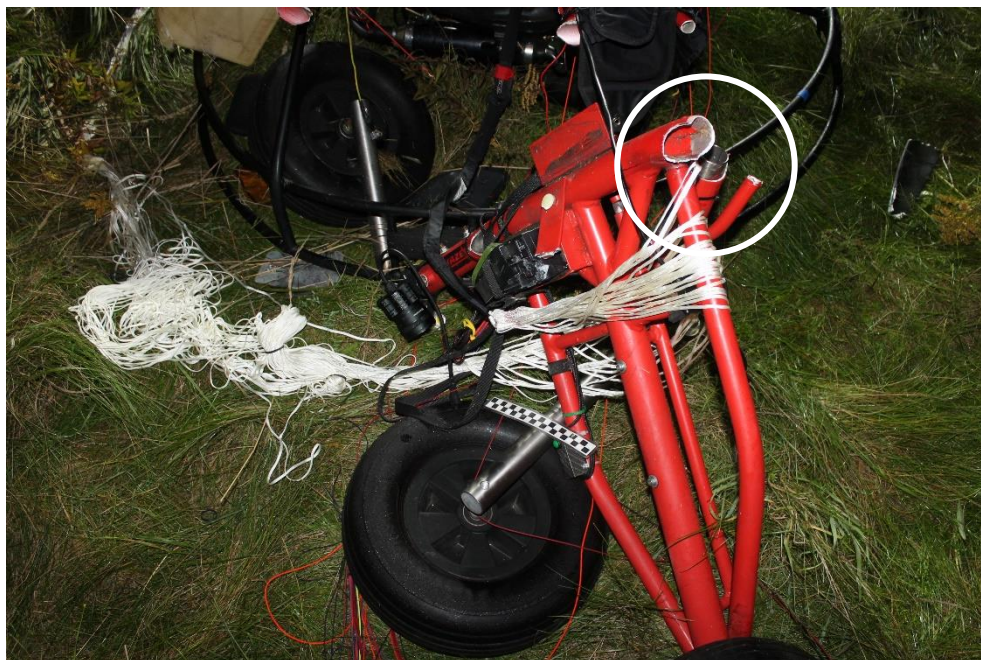
Rys. 3. Pocięty i połamany fragment konstrukcji ramy wózka motoparalotni [źródło: materiał od policji]
