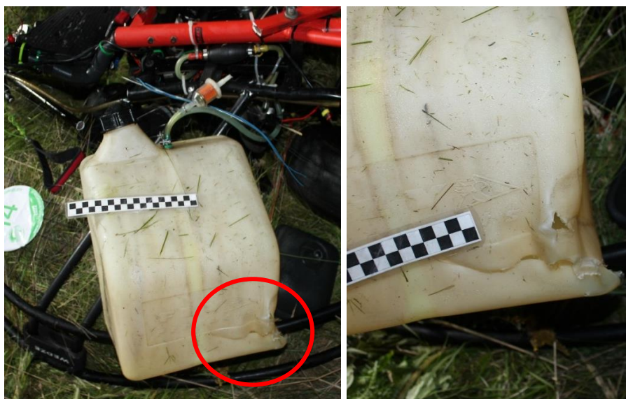
Rys. 7. Rozcięty śmigłem zbiornik paliwa [źródło: materiał od policji]
