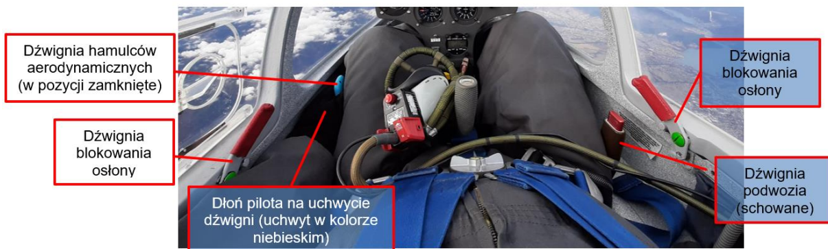
Rys. 7. Ergonomia operowania dźwigniami hamulców aerodynamicznych (uchwyt po lewej, kolorze niebieskim), dźwignią wysuwania podwozia (uchwyt po prawej, w kolorze brązowym z czerwonym przyciskiem blokady) oraz położenie dźwigni blokowania osłony kabiny (zamków - w pozycji „zablokowane”) w szybowcu SZD-48-1 „Jantar Std. 2” [źródło: PKBWL]
