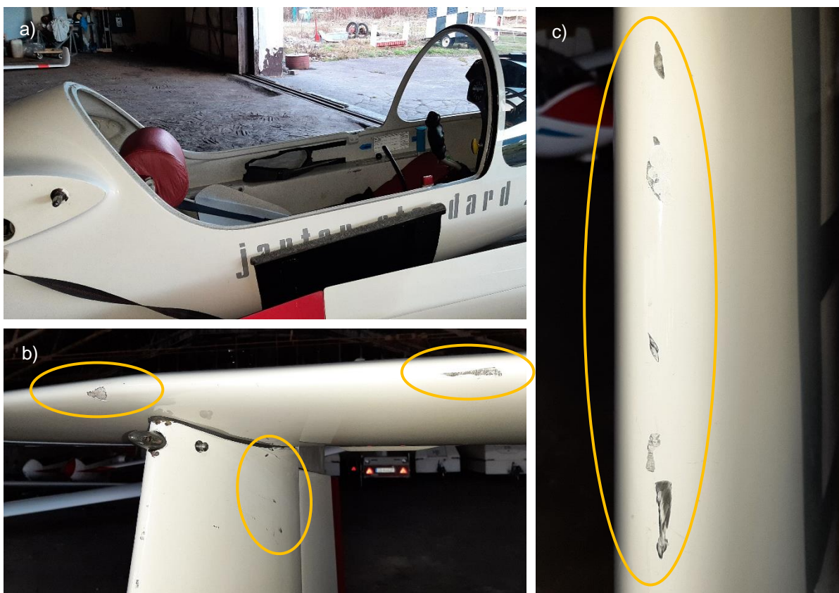
Rys. 2. Uszkodzenia szybowca: a) kadłub pozbawiony ruchomej części osłony kabiny, b) statecznik poziomy, c) krawędź natarcia statecznika pionowego [źródło: PKBWL]
