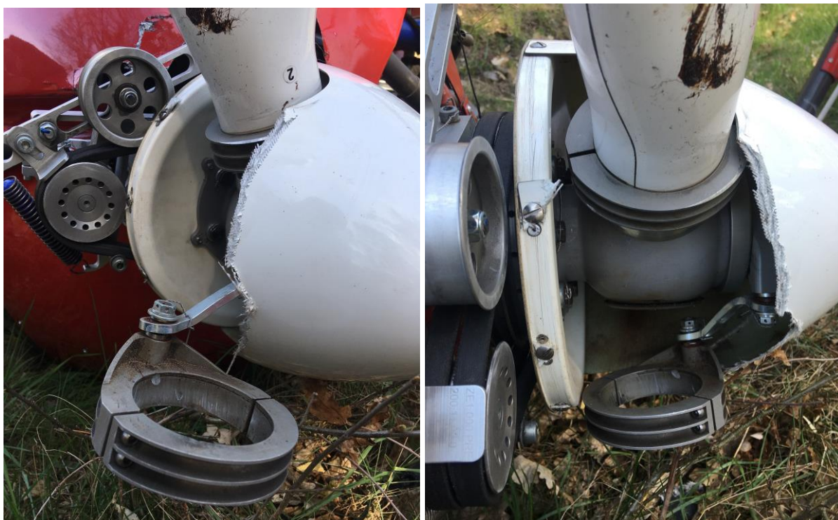
Rysunek 3. Uszkodzona piasta śmigła wiatrakowca biorącego udział w zdarzeniu [Źródło: PKBWL]
