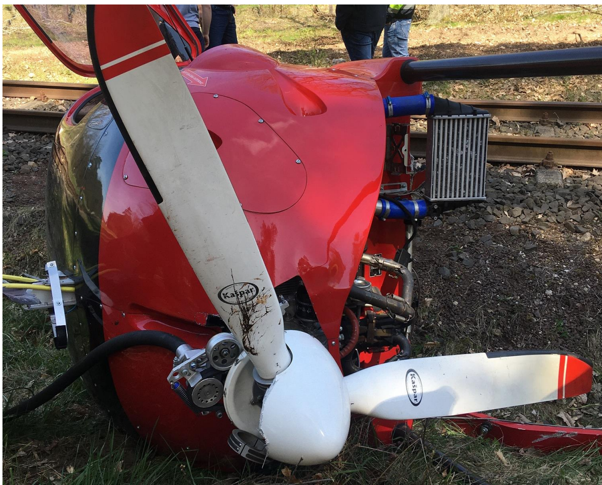
Rysunek 2. Wiatrakowiec biorący udział w zdarzeniu po wykonaniu lądowania awaryjnego [Źródło: PKBWL]
