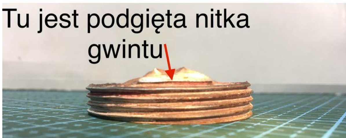
Rysunek 10. Miejsce strefy dołamania z charakterystycznym podgięciem nitki gwintu [Źródło: Politechnika Warszawska]
