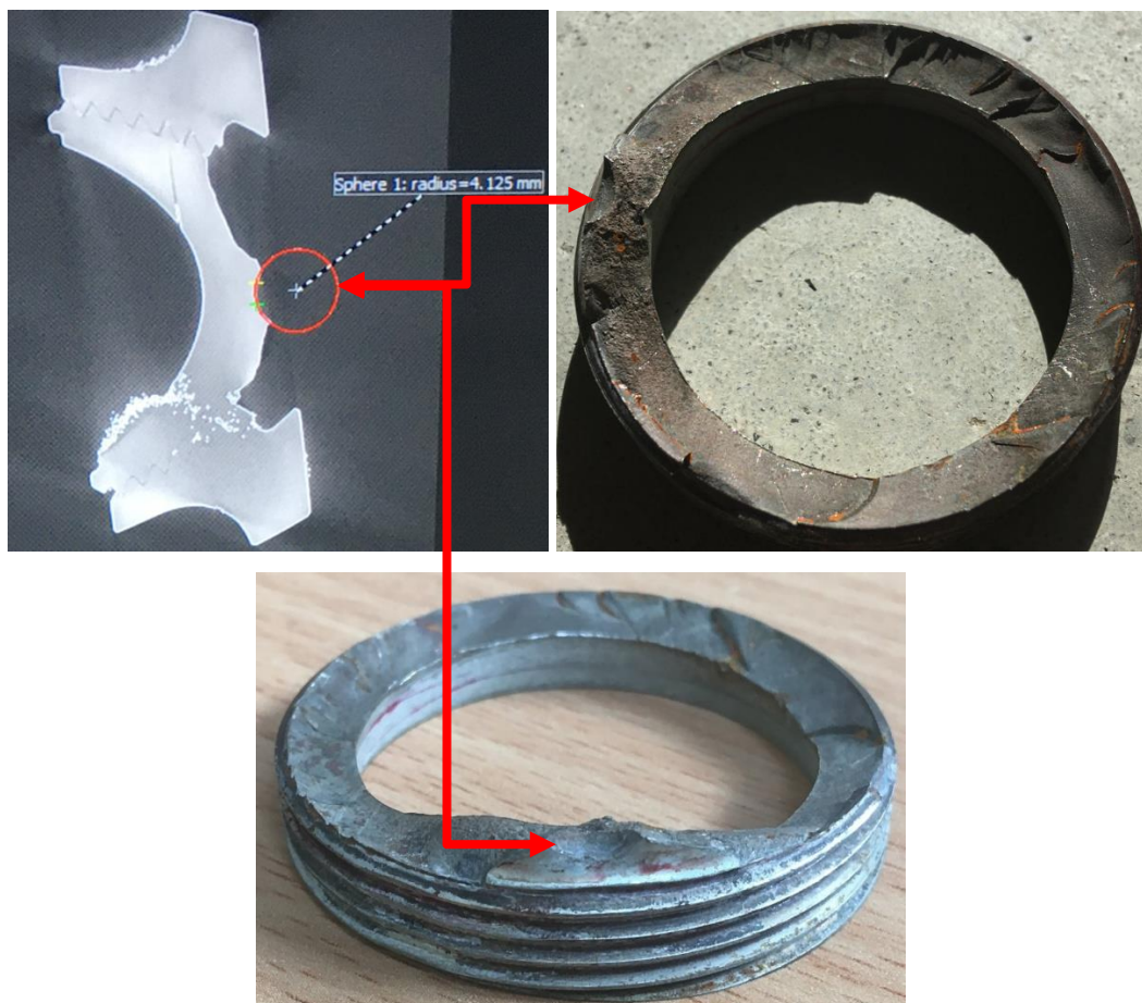
Rysunek 15. Miejsce odłamania o kształcie sferycznym [Źródło: Politechnika Warszawska]
