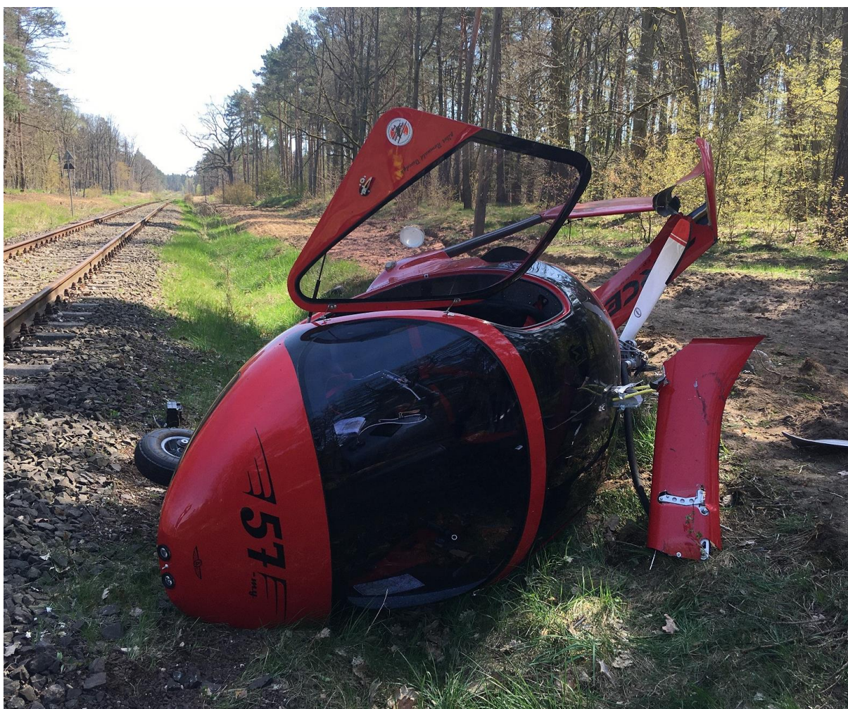
Rysunek 1. Wiatrakowiec biorący udział w zdarzeniu po wykonaniu lądowania awaryjnego [Źródło: PKBWL]
