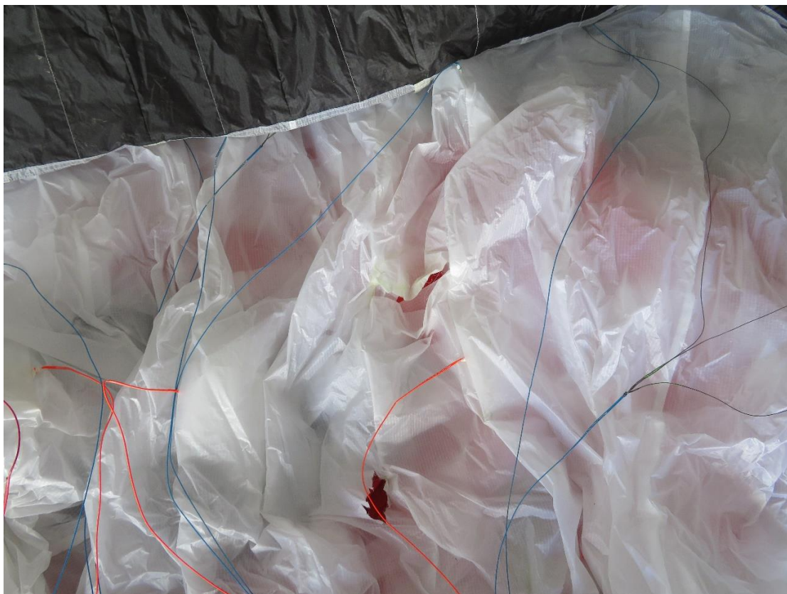
Rys.2- uszkodzenia skrzydła przez urwane końcówki łopat śmigieł [Źródło PKBWL]
