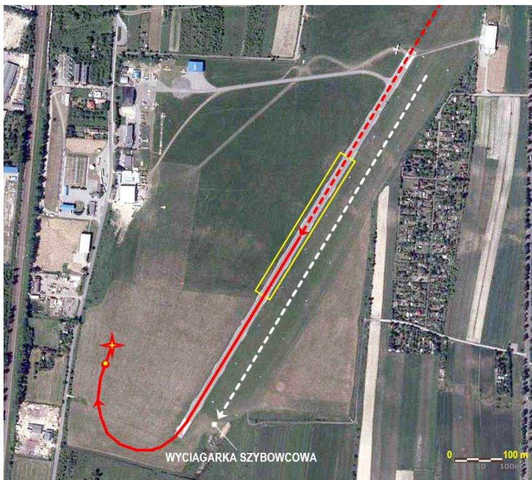
Rysunek 1. Końcowy odcinek trasy lotu zakończonego wypadkiem, gdzie: czerwona linia przerywana – podejście do lądowania, żółty prostokąt – strefa wykonania konwojera i niskiego przelotu, czerwona linia ciągła – strefa wznoszenia i wejścia w zakręt (na końcu zaznaczone miejsce zderzenia z ziemią i miejsce zatrzymania samolotu), biała przerywana linia – start szybowcowy i położenie wyciągarki (miejsce zajmowane przez naoczego świadka) [podkład: Geoportal].
