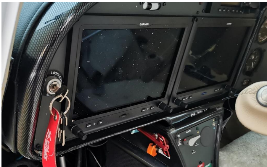
Rys. 9 Garmin G3X zabudowany w tablicy przyrządów samolotu OK UUA 92 [źródło: PKBWL]
