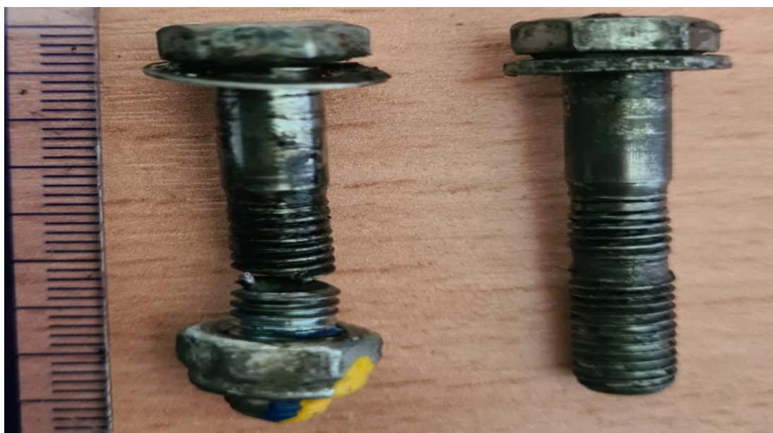
Rys. 1. Urwana i uszkodzona śruba mocowania zawieszenia usterzenia płytowego [źródło: PKBWL].
