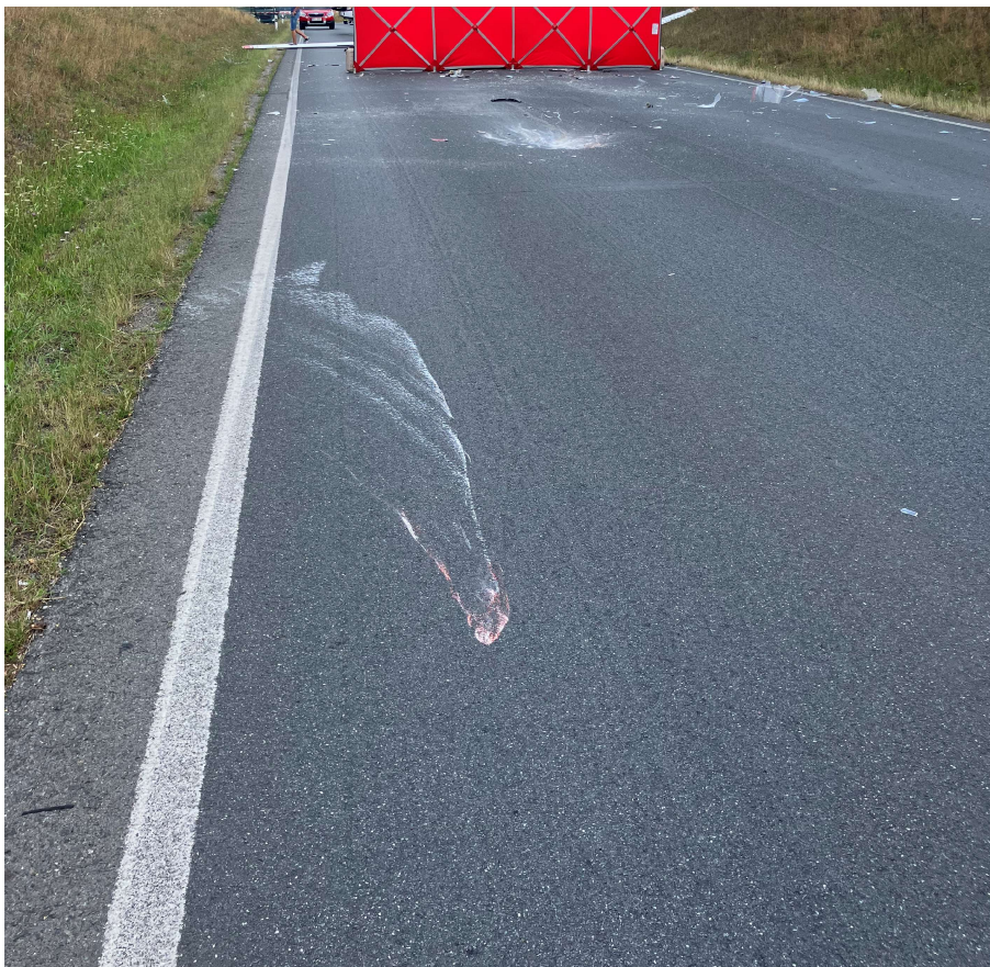
Obr. č. 8: Stopy otěru pravé poloviny křídla a přední části kluzáku
