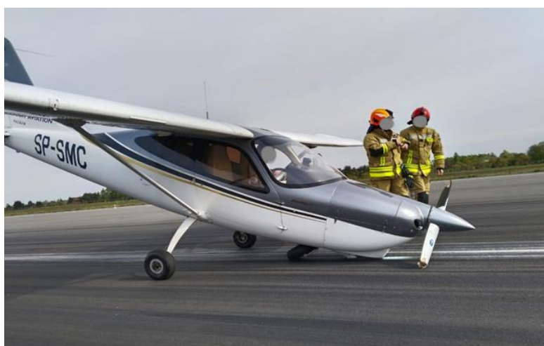
Rysunek 1 Uszkodzenia samolotu spowodowane złamaniem przedniej nogi
