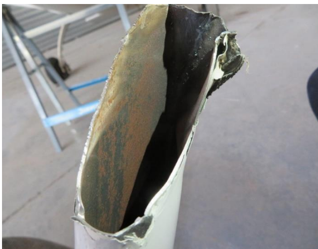
Rysunek 2. Widok przełomu i wewnętrznej części urwanej goleni
