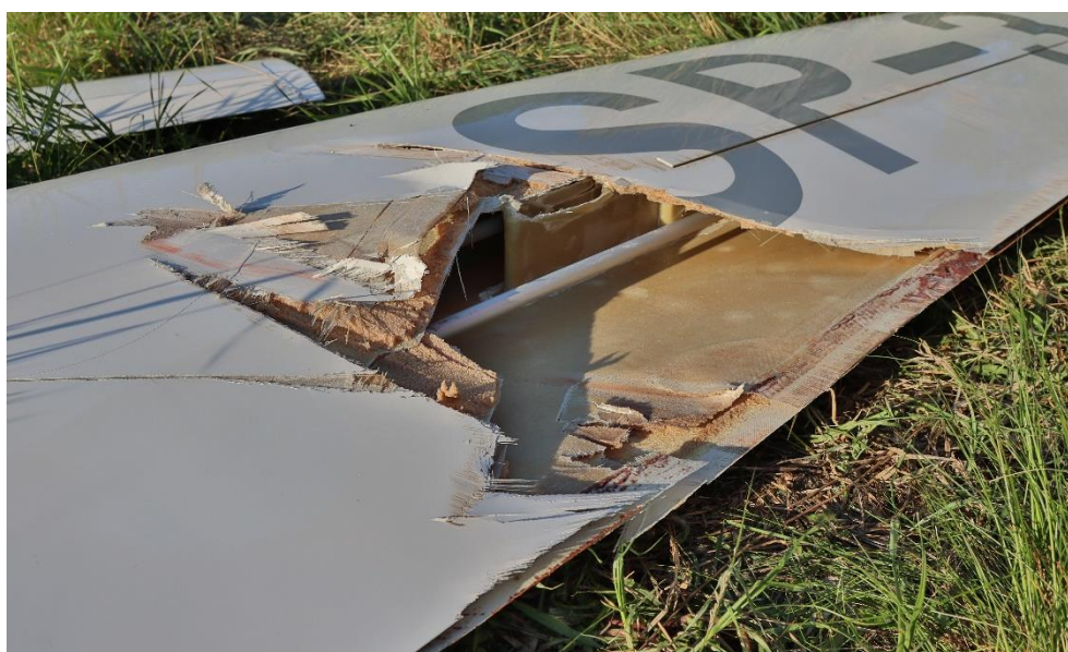
Rys. 4 Rozerwana i rozwarstwiona struktura dolnej strony lewego skrzydła [źródło: Aeroklub Białostocki]
