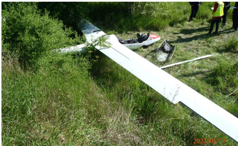
Rys. 9 Położenie szybowca po zdarzeniu. Widoczny jest brak lotki na prawym skrzydle, oderwana osłona kabiny oraz zniekształcenia kadłuba w strefie dziobowej [źródło: Aeroklub Białostocki]
