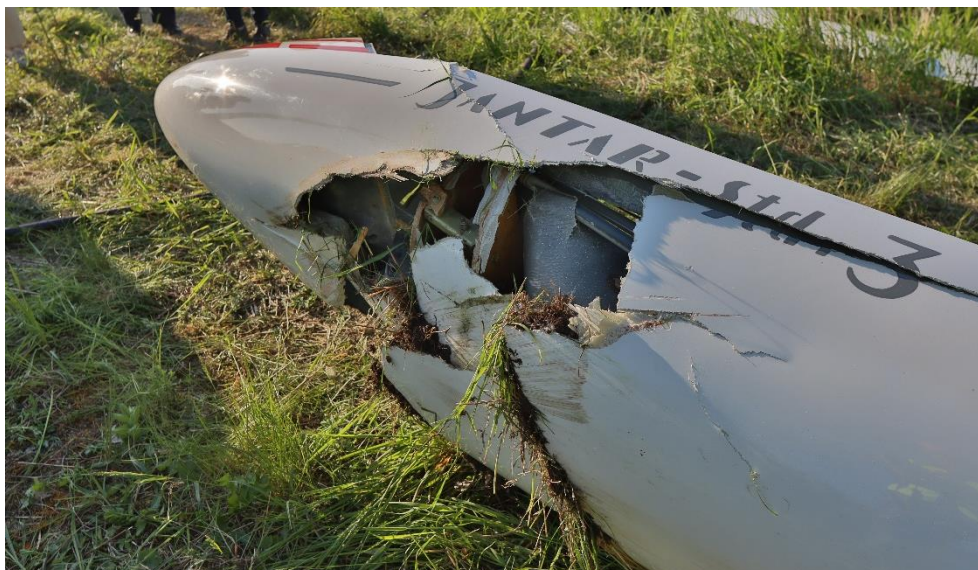
Rys. 3 Zniszczony kadłub w strefie kabiny pilota [źródło: Aeroklub Białostocki]
