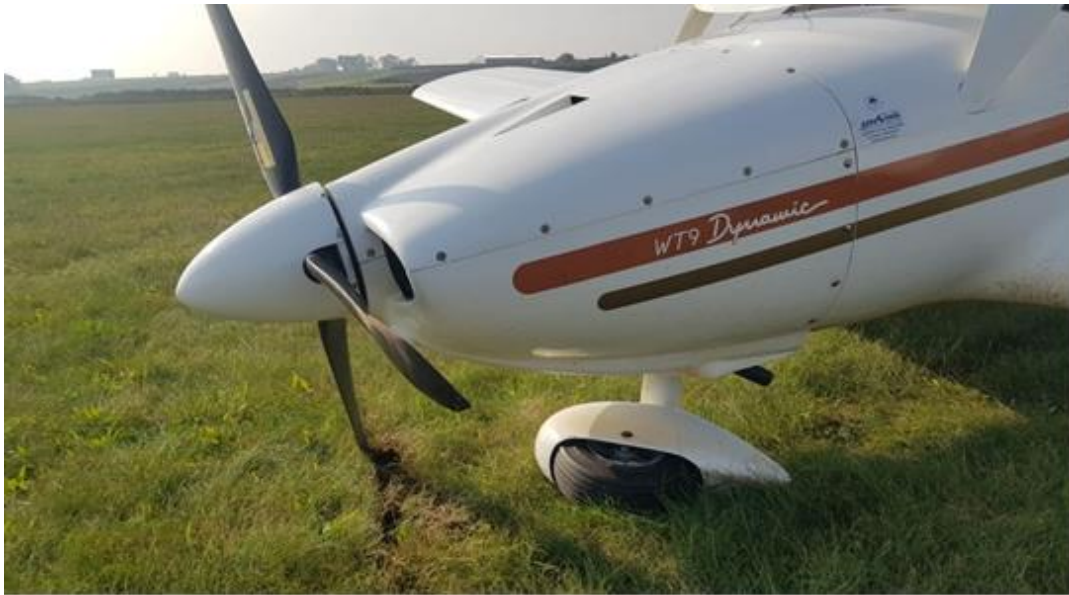
Rys. 1 Złamana przednia goleń podwozia oraz widoczny kontakt łopatek śmigła z nawierzchnią lotniska (źródło: użytkownik).
