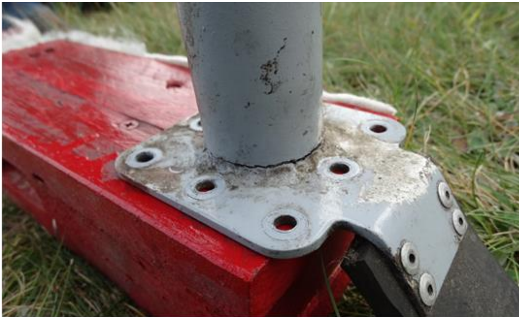
Rys. 2 Pęknięcie przedniej goleni podwozia samolotu w miejscu połączenia (źródło użytkownik)
