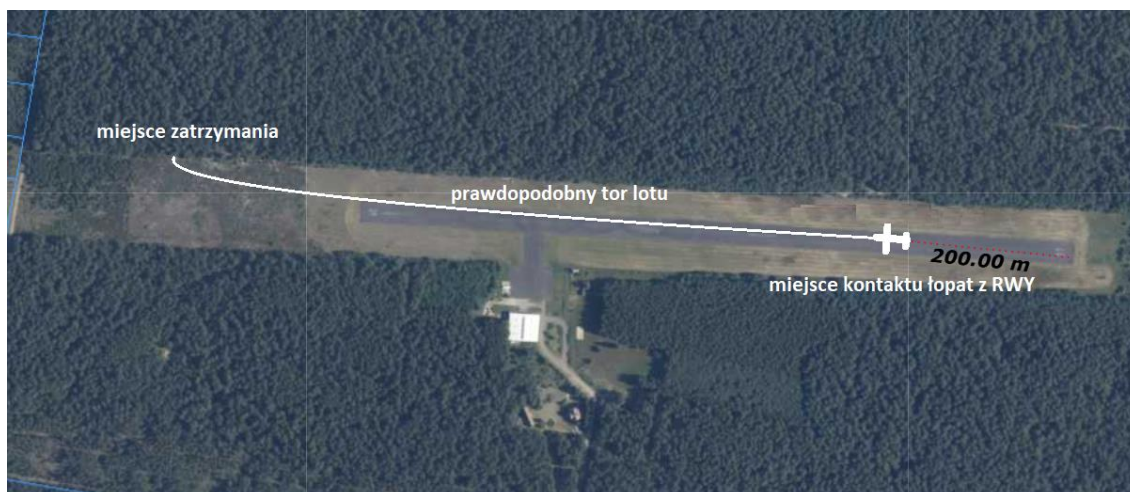
Rysunek 14. Prawdopodobne miejsce kontaktu łopaty pracującego silnika i trajektoria dobiegu i miejsca zatrzymania samolotu po zderzeniu z ogrodzeniem i drzewem [źródło: https://mapy.geoportal.gov.pl/ , PKBWL]
