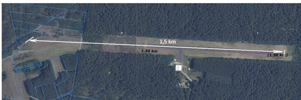
Rysunek 18. Odległość od progu RWY27 do najbliższej przeszkody terenowej (ściany lasu)
