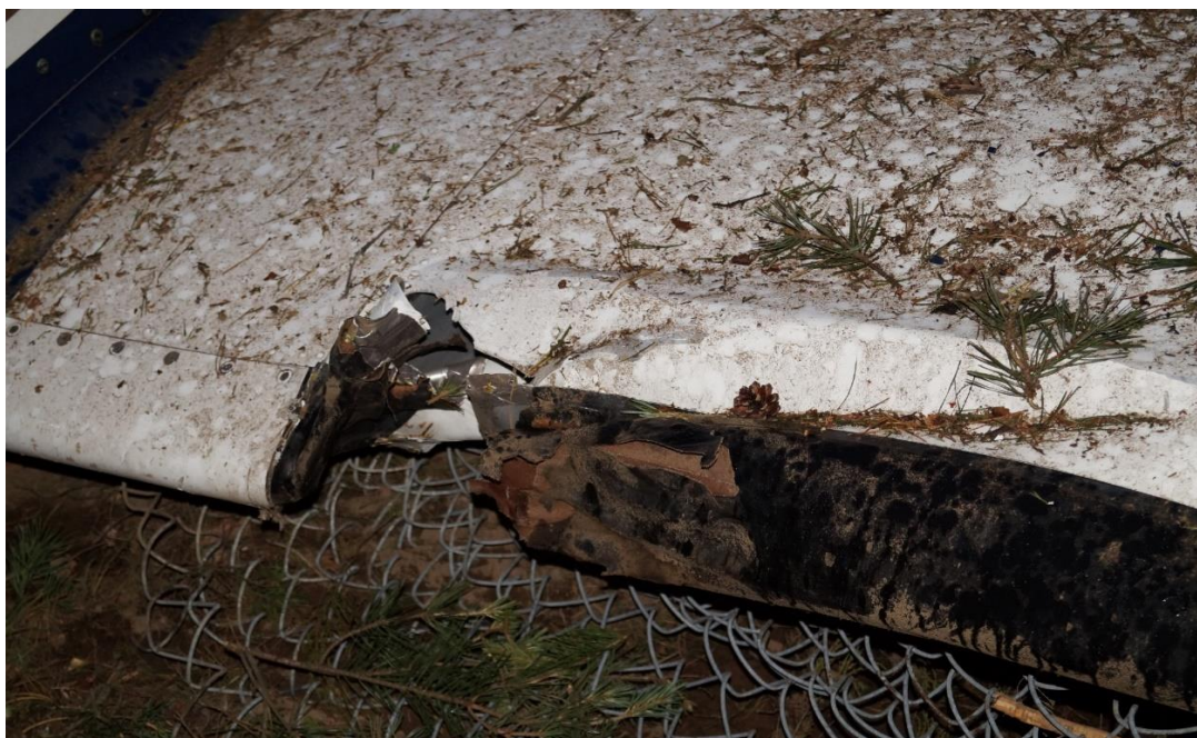
Rysunek 13. Uszkodzony keson lewego skrzydła w okolicy łoża silnika
