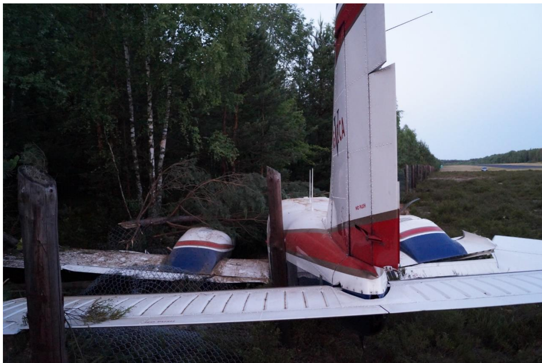
Rysunek 11. Unieruchomienie samolotu przez słup ogrodzeniowy
