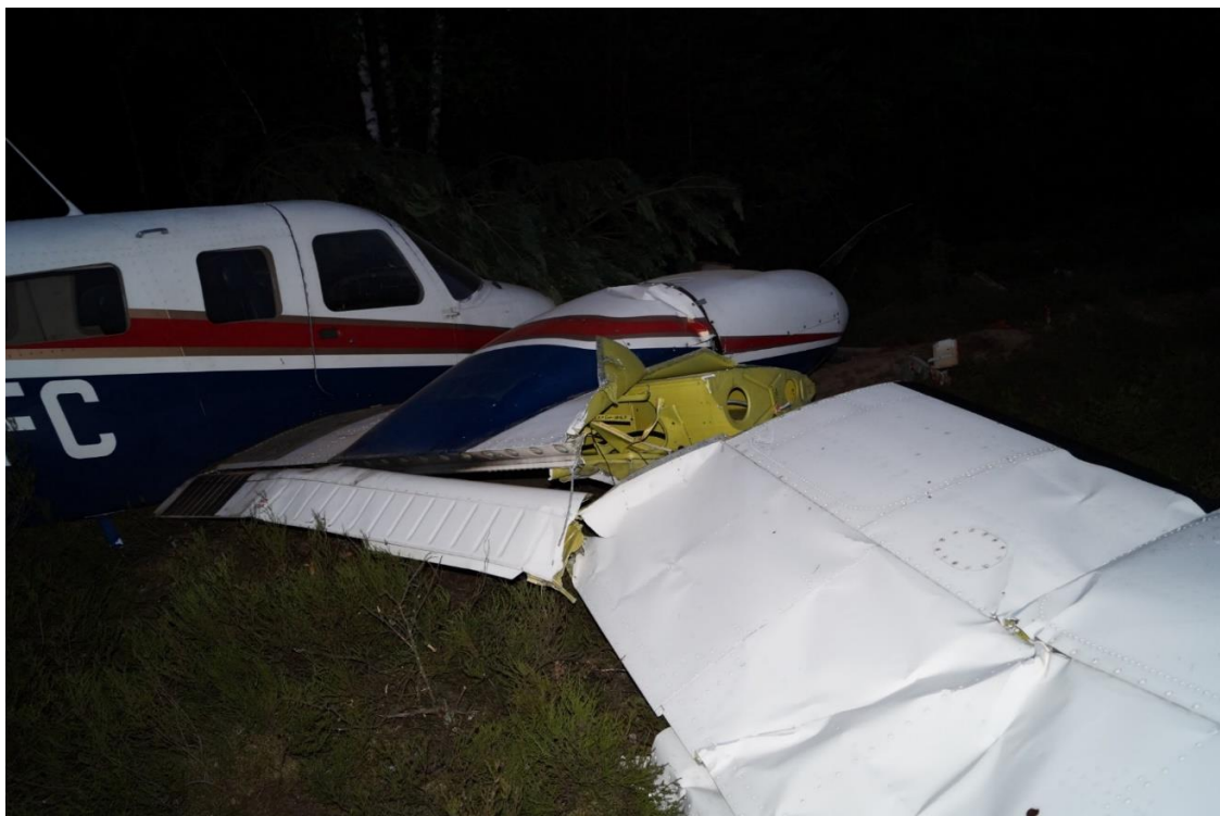
Rysunek 12. Zniszczenia prawego skrzydła
