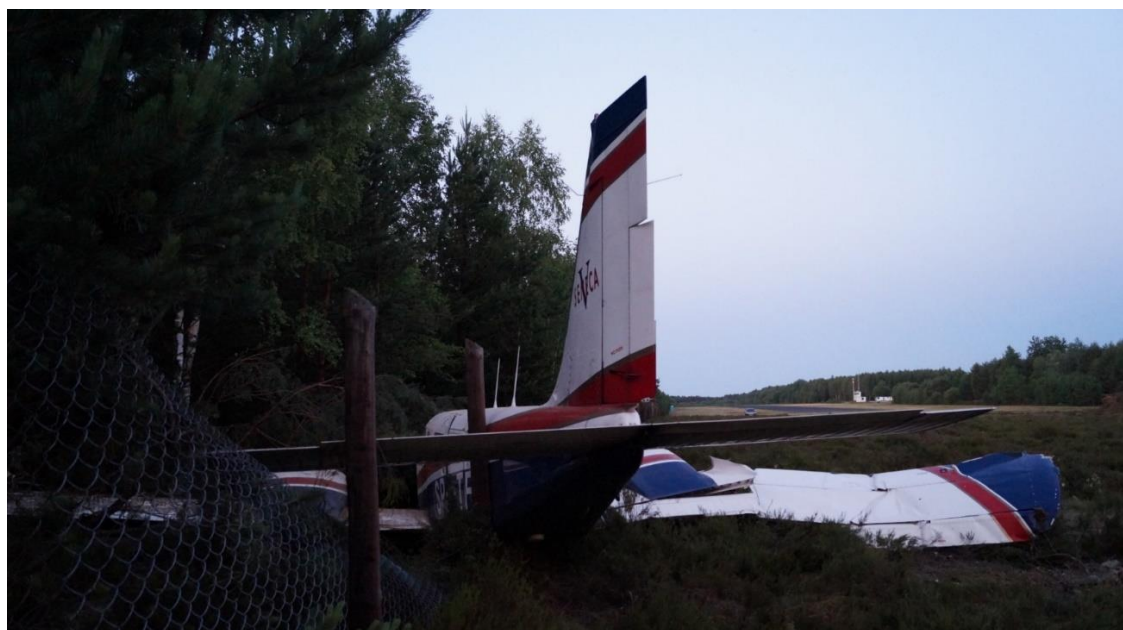
Rysunek 2. Samolot Piper PA-34-220T po zderzeniu z ogrodzeniem lądowiska. Na drugim planie widoczna RWY oraz zabudowania lądowiska
