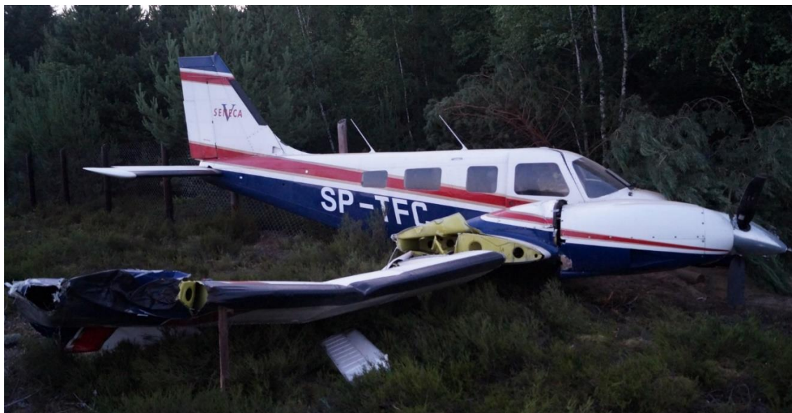
Rysunek 3. Zdeformowane i oderwane prawe skrzydło oraz naderwane łożo silnika
