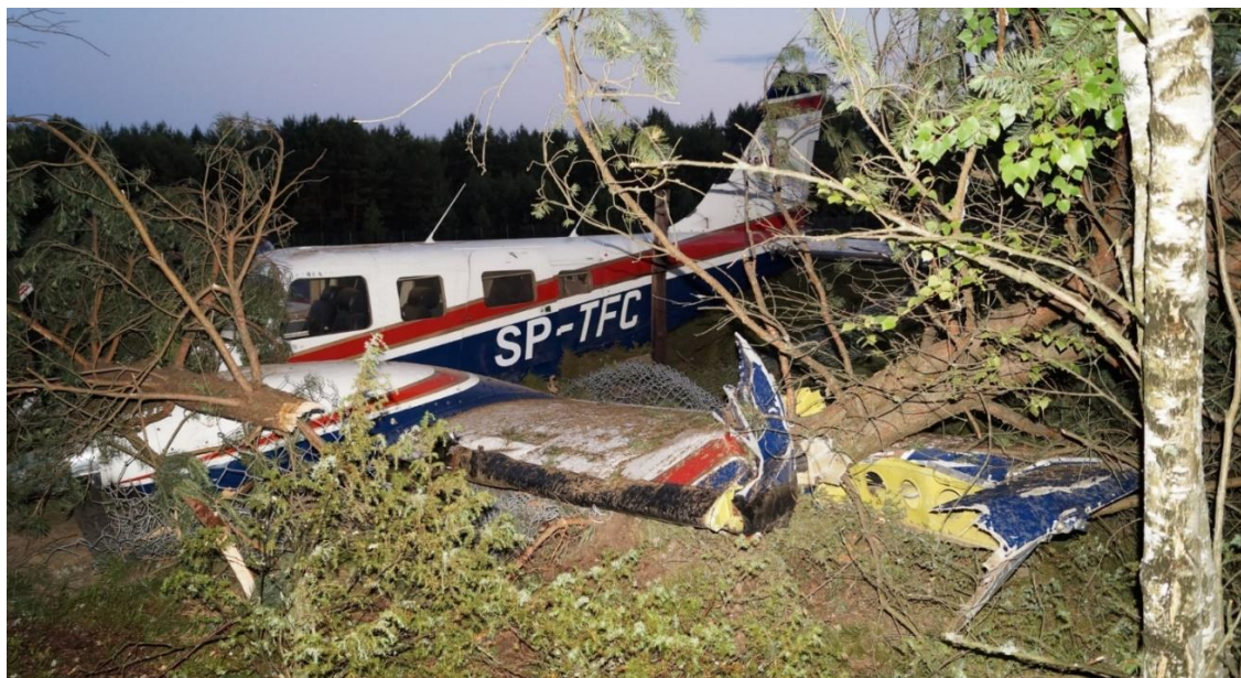
Rysunek 4. Zniszczenia lewego skrzydła
