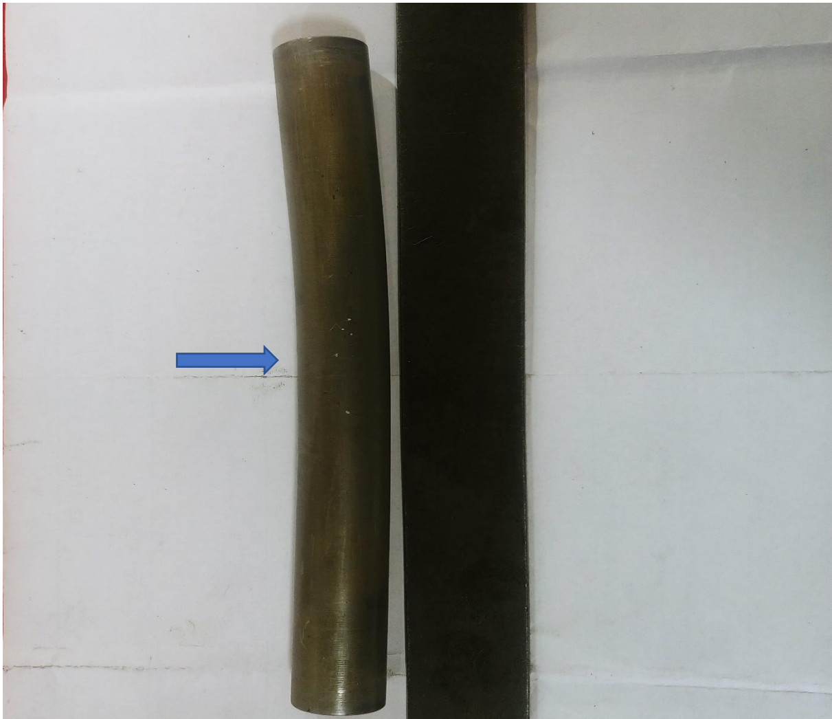
Rysunek 4. Wygięta oś przedniego koła.
