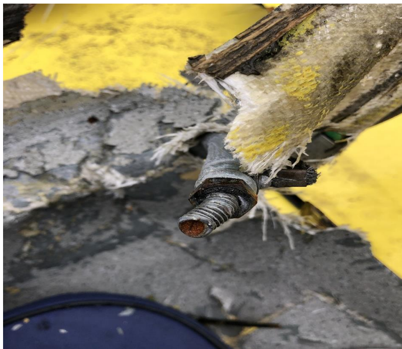
Rys. 12. Widok zerwanej końcówki oczkowej, w układzie sterowania sterem wysokości w obrębie sterownicy
