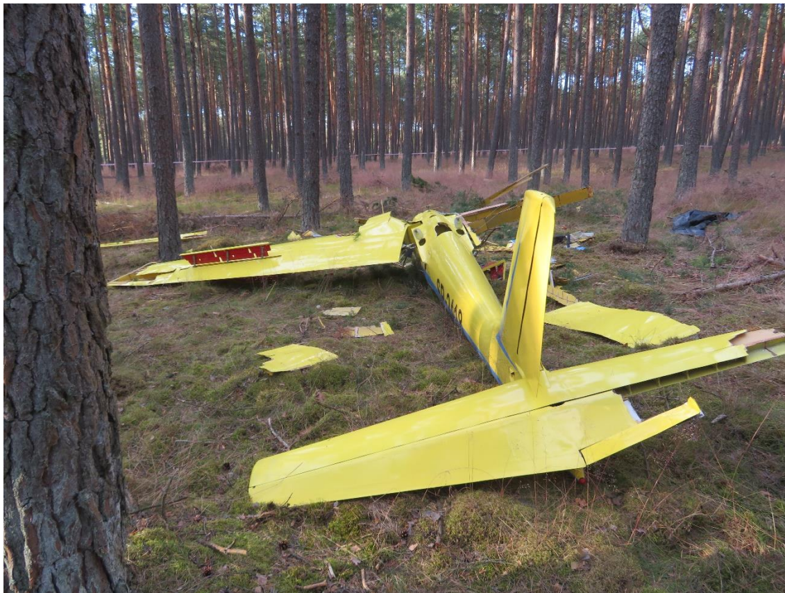
Rys. 3. Widok zniszczonego szybowca od strony ogona
