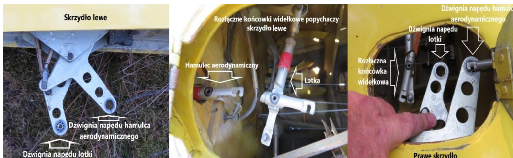
Rys. 11. Widok stanu połączeń napędów sterowania lotkami i hamulcami aerodynamicznymi po wypadku
