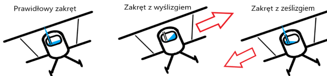
Rysunek 7. Na szkicu pokazano, jak przemieszczało się paliwo w zbiorniku zamontowanym na samolocie w trakcie wykonywania zakrętu
