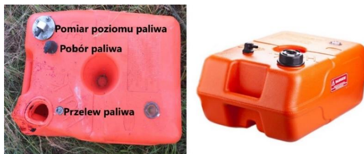
Rysunek 4. Zbiornik paliwa zdemontowany z samolotu i z oferty handlowej. [źródło: PKBWL, Internet]
