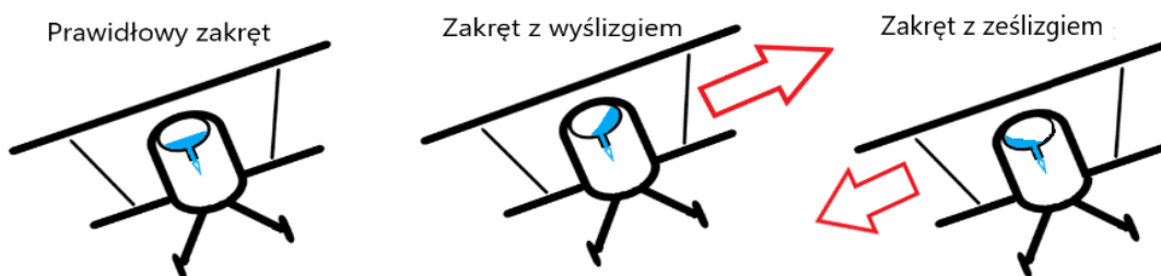
Rysunek 6. Na szkicu pokazano, jak przemieszcza się paliwo w zbiorniku o kształcie owalnym w trakcie wykonywania zakrętu
