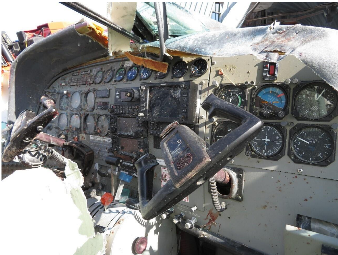
Rysunek 13. Kokpit samolotu Cessna 208B, SP-WAW po wypadku, gdzie widać, że prawy wolant jest czysty, w miejscach położenia dłoni
