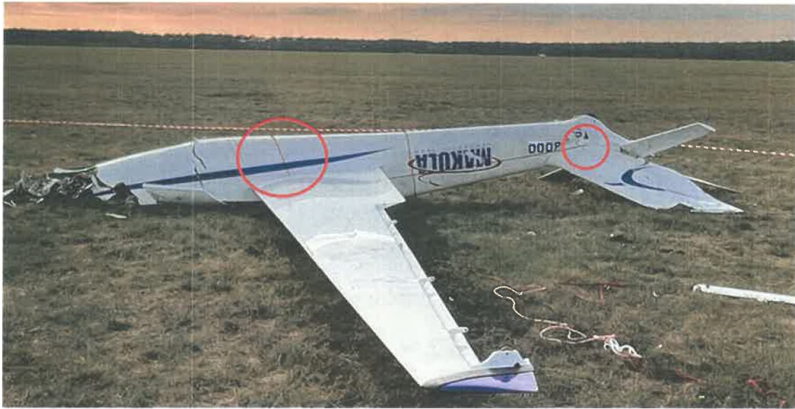
Rysunek 10. Wrak szybowca z widoczną liną holowniczą [źródło: Michał Klimaszewski]
