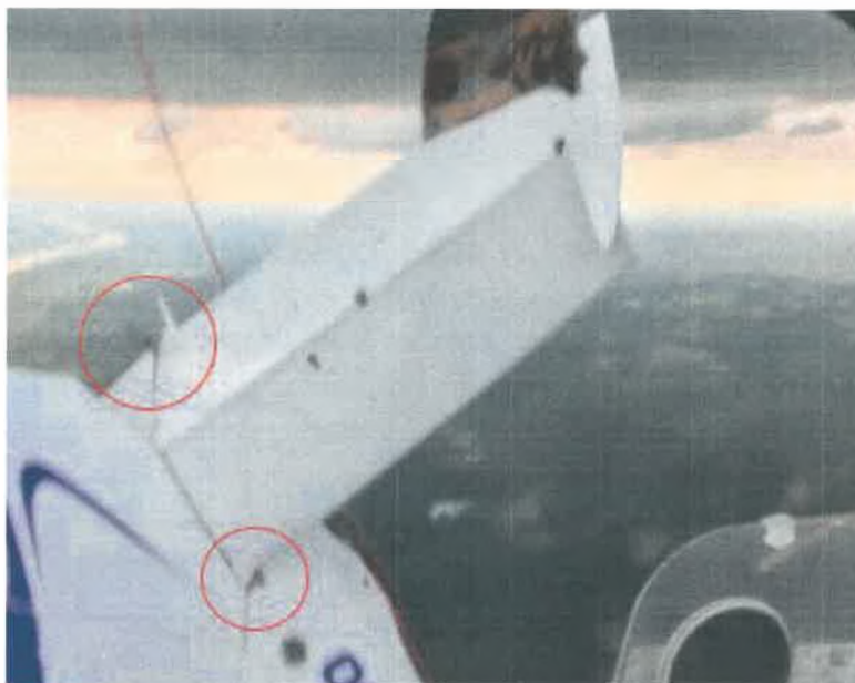
Rysunek 4. Widok na zablokowany liną holowniczą ster wysokości [źródło: kamera zamontowana na owiewce kabiny]
