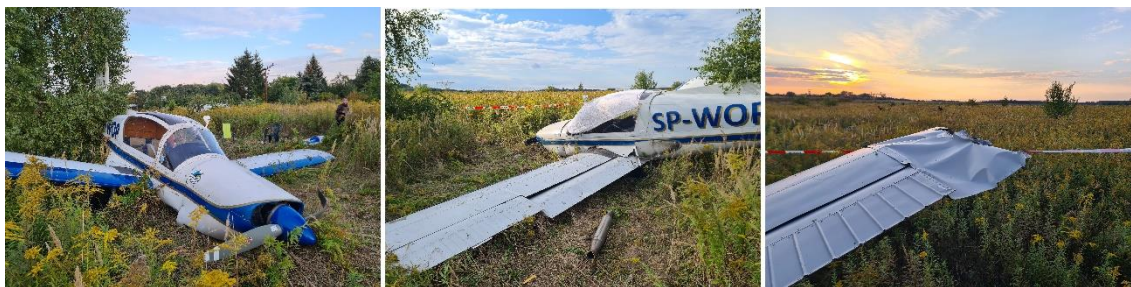
Rysunek 3. Socata-Ralley 235 E-D – wrak samolotu (widoczne uszkodzenia konstrukcji)
