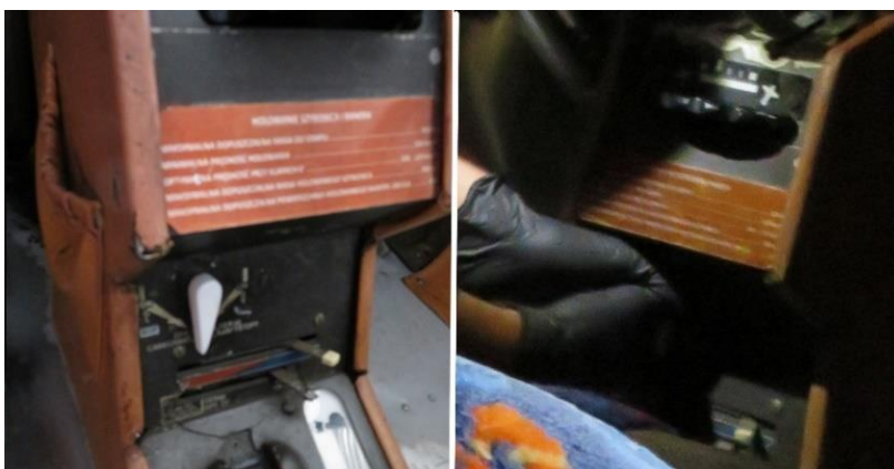
Rysunek 8. Położenie dźwigni zaworu paliwa po zdarzeniu. Próba przestawienia dźwigni zaworu paliwa.
