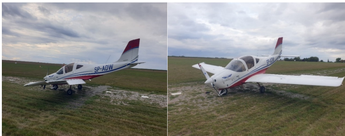
Rysunek 1. Uszkodzenia przedniej goleni oraz widoczne nierówności nawierzchni trawiastej DS
