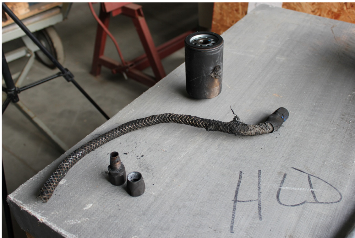
Foto 14. Uszkodzony przewód olejowy, króciec montażowy zdemontowany z głowicy silnika i filtr olejowy (foto PKBWL).
