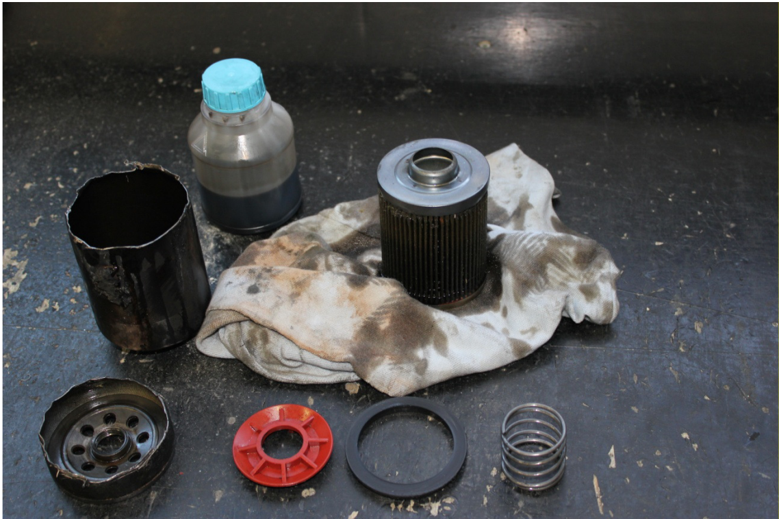
Foto.15. Filtr oleju po rozmontowaniu - w pojemniku odzyskany olej z filtra (foto PKBWL).
