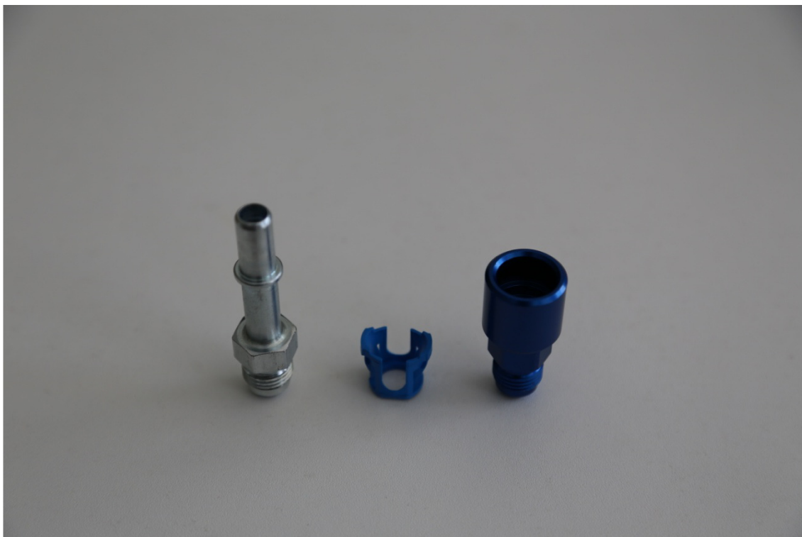
Fot.8. Badane złącze paliwowe, od lewej: króciec 3/8 cala, wkładka z tworzywa sztucznego zabezpieczająca złącze przed rozłączeniem, korpus złączki 3/8 cala (żeńska) (foto PKBWL).
