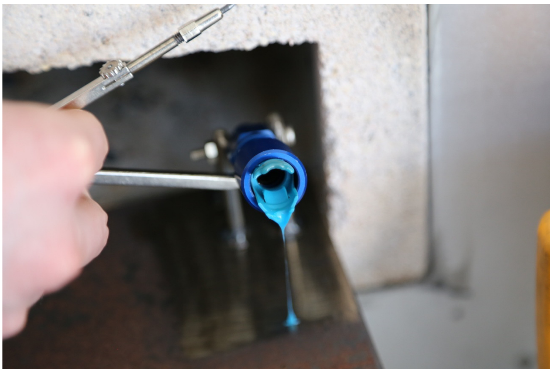
Fot. 11. Widok wkładki z tworzywa sztucznego po pierwszej próbie (foto PKBWL).
