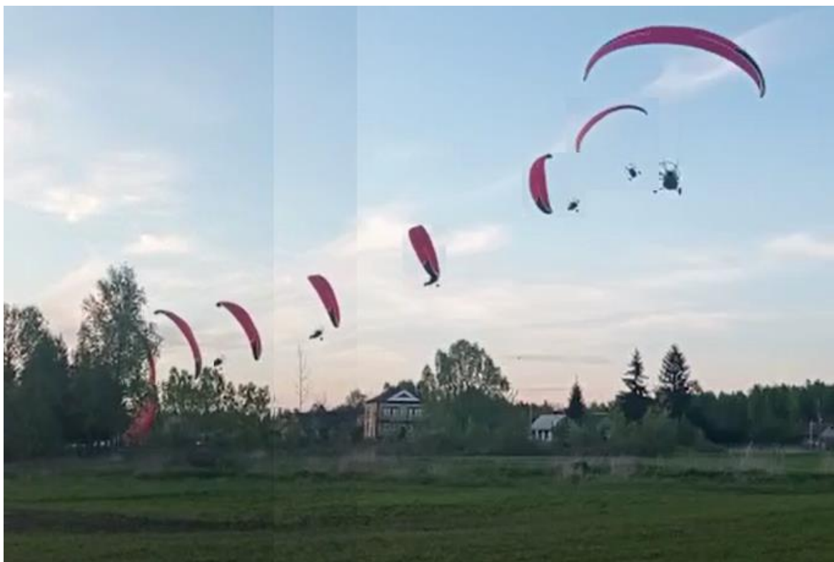
Rysunek 10. Kolejne pozycje motoparalotni wprowadzonej w zakręt, aż do chwili zderzenia z ziemią [źródło: kadr z materiału video pozyskanego od świadka]
