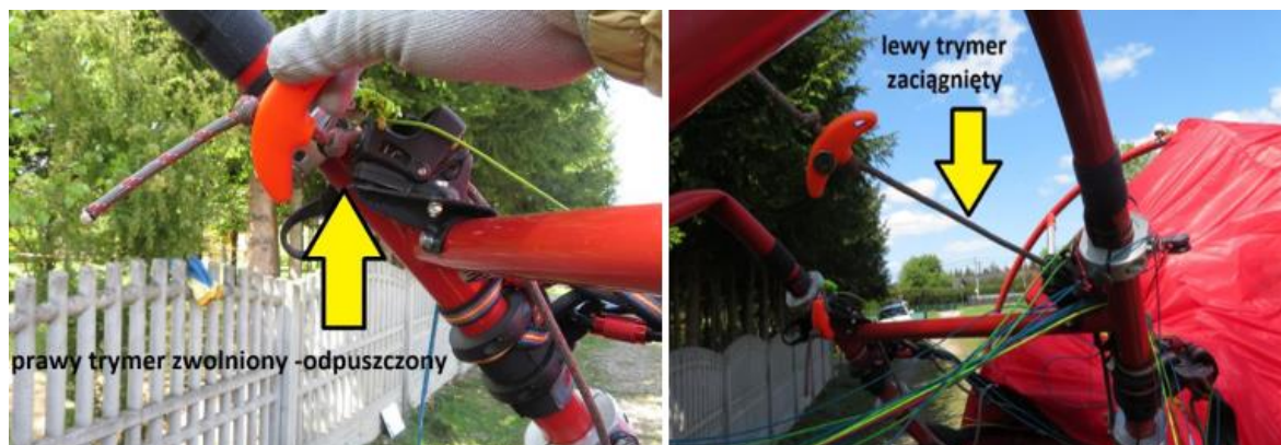
Rysunek 6. Całkowicie odpuszczony prawy trymer, a lewy zaciągnięty
