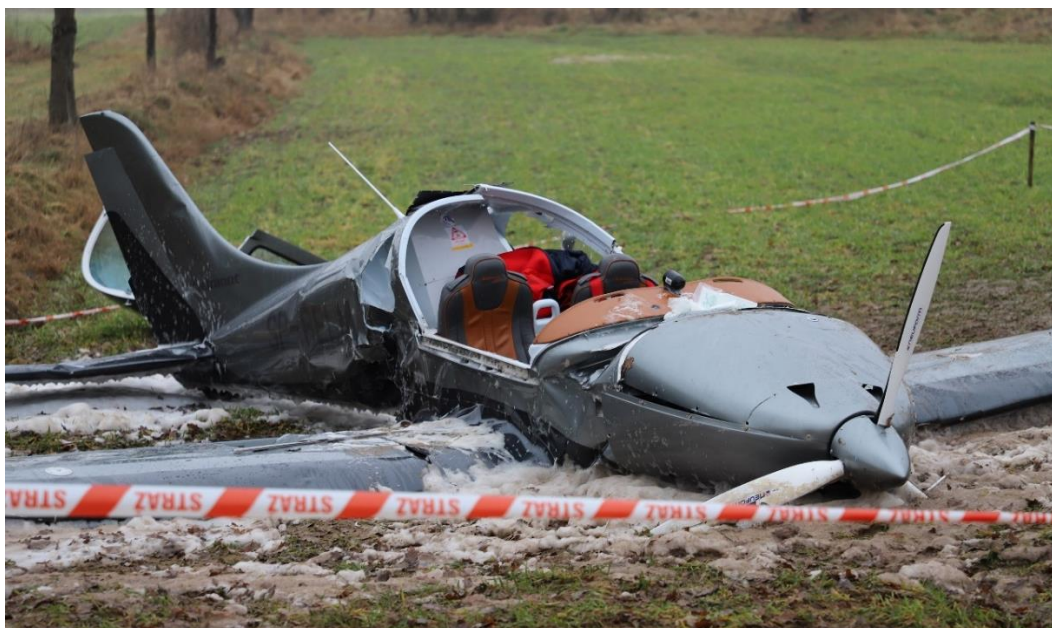
Rysunek 1. Samolot BELMONT DW 200, SP-BELM na miejscu wypadku. Widoczne przełamanie kadłuba za kabiną załogi
