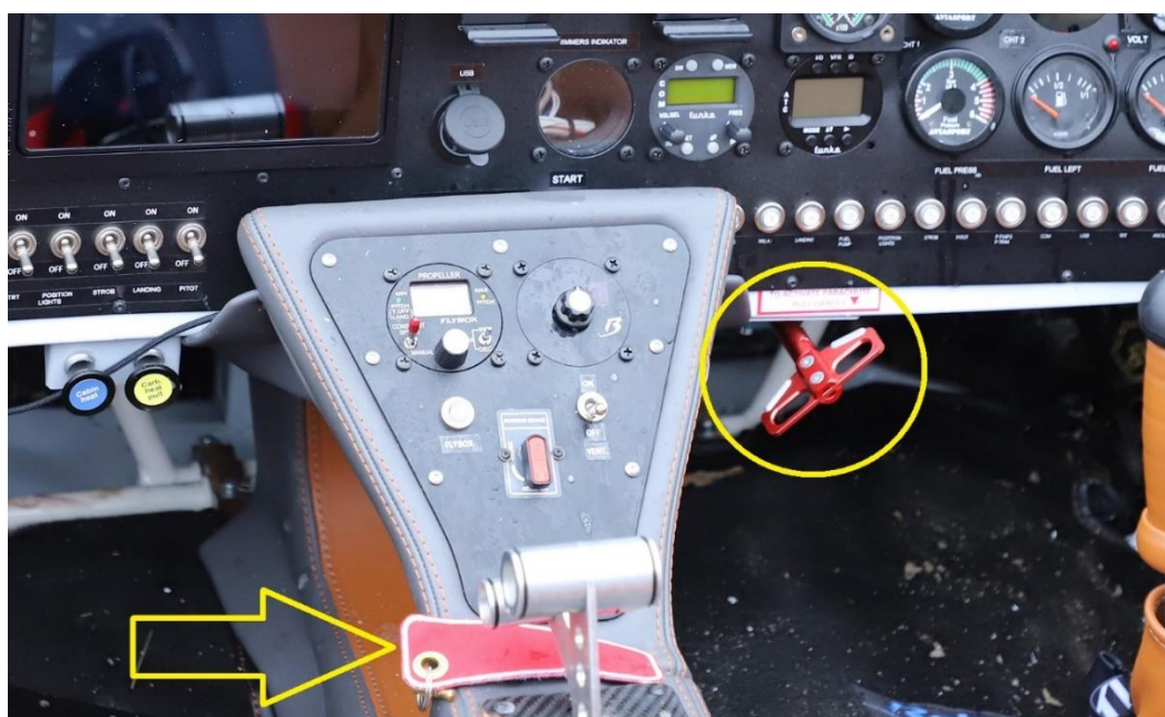
Rysunek 9. System GRS zamontowany w samolocie SP-BELM. Żółtym okręgiem zaznaczono dźwignię służącą do uruchomienia systemu, a żółtą strzałką zawleczkę zabezpieczającą ww. dźwignię podczas postoju samolotu na ziemi
