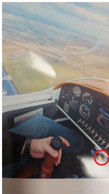
Rysunek 14. Stan położenia dźwigni sterowania podgrzewem gaźników w trakcie lotu (czerwone kółko) – [źródło: Pasażer samolotu Belmont DW 200, SP-BELM].
