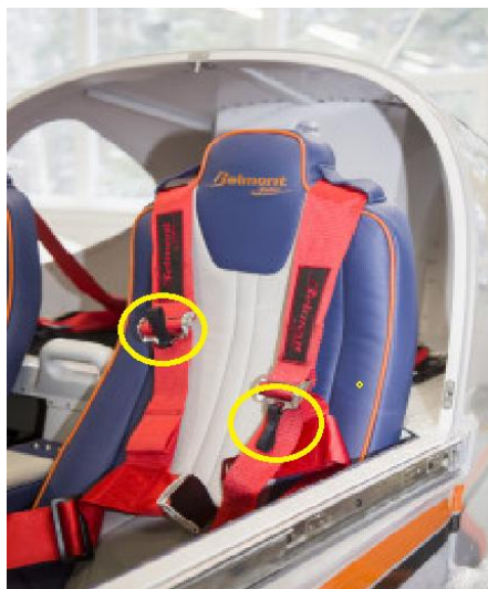
Rysunek 16 . Pasy bezpieczeństwa fotela pilota. Żółtym kolorem zaznaczono klamry służące do regulacji naciągu pasów plecowych (zdjęcie producenta samolotu Belmond DW200, SP-BELM).
