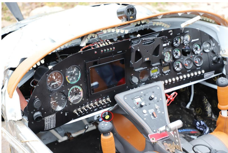
Rysunek 11. Położenie przełączników na tablicy przyrządów samolotu Belmont DW200, SP-BELM (w czerwonym kółku położenie dźwigni sterowania podgrzewem gaźników). Stan po zderzeniu samolotu z ziemią.
