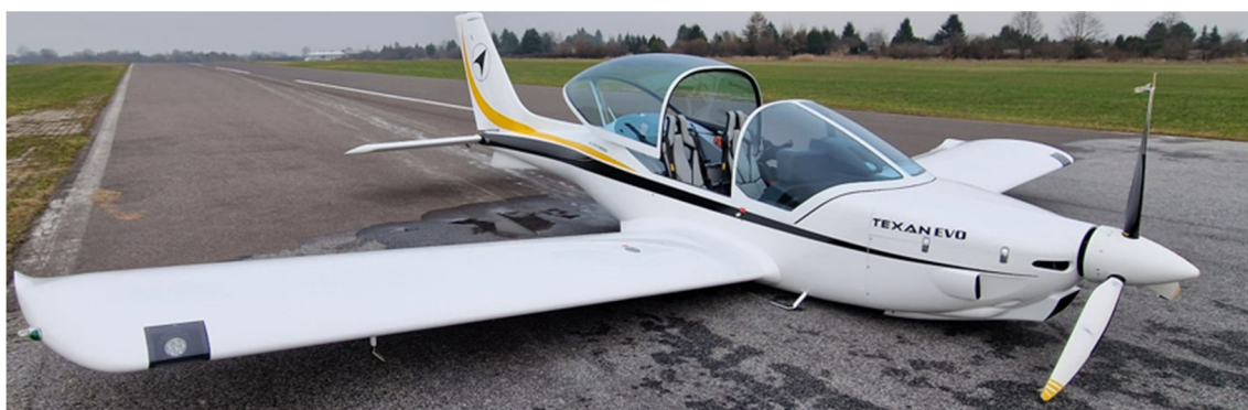
Rys 1. Samolot TEXAN EVO 915 IS turbo po przyziemieniu bez podwozia na lotnisku EPPT. (Źródło: PKBWL).
