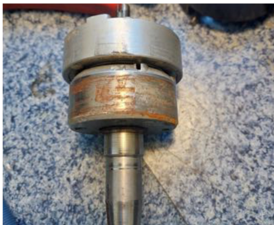
Rys. 9. Widoczna korozja na stojanie iskrownika
