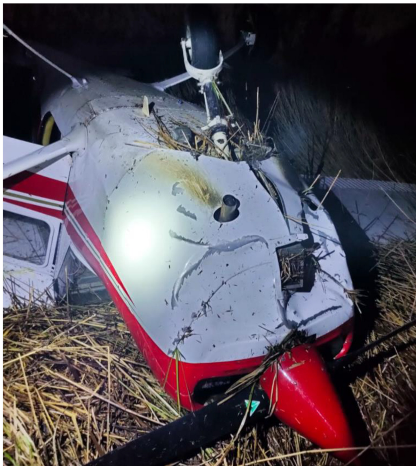
Rys. 6. Widok uszkodzeń przedniej części kadłuba
