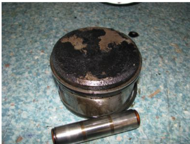
Rys. 12. Widoczny ciemny nalot nagaru na tłoku
