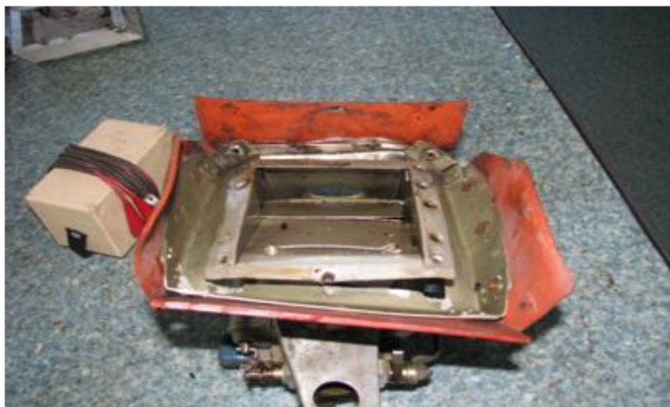
Rys. 11. Widoczna przepustnica ciepłego powietrza oraz zdeformowana obudowa wlotu powietrza
