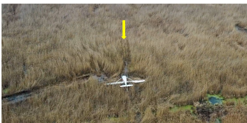
Rys. 2. Położenie samolotu po kapotażu oraz zaznaczone żółtą strzałką miejsce jego przyziemienia
