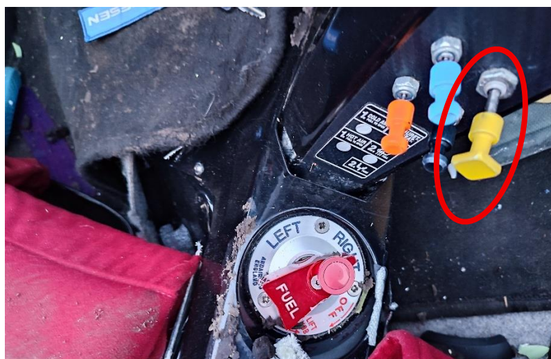
Rysunek 16. Zaznaczono wyciągniętą gałkę podgrzewu gaźnika
