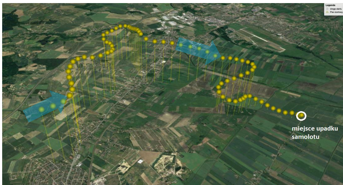
Rysunek 11. tor lotu w dolocie do punktu zdarzenia
