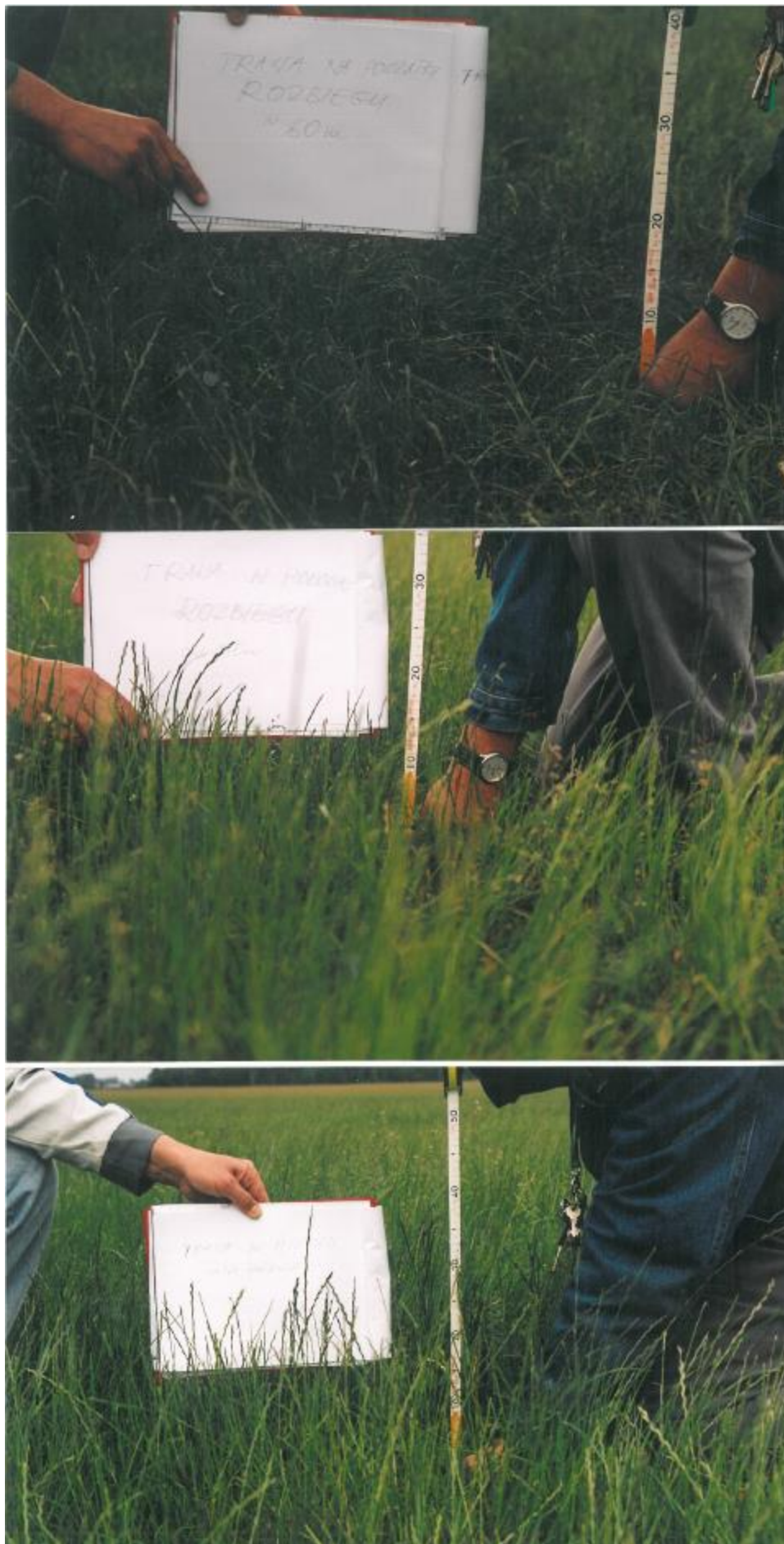
Fot. 2 Pomiar wysokości trawy od miejsca rozpoczęcia rozbiegu do zatrzymania szybowca.
