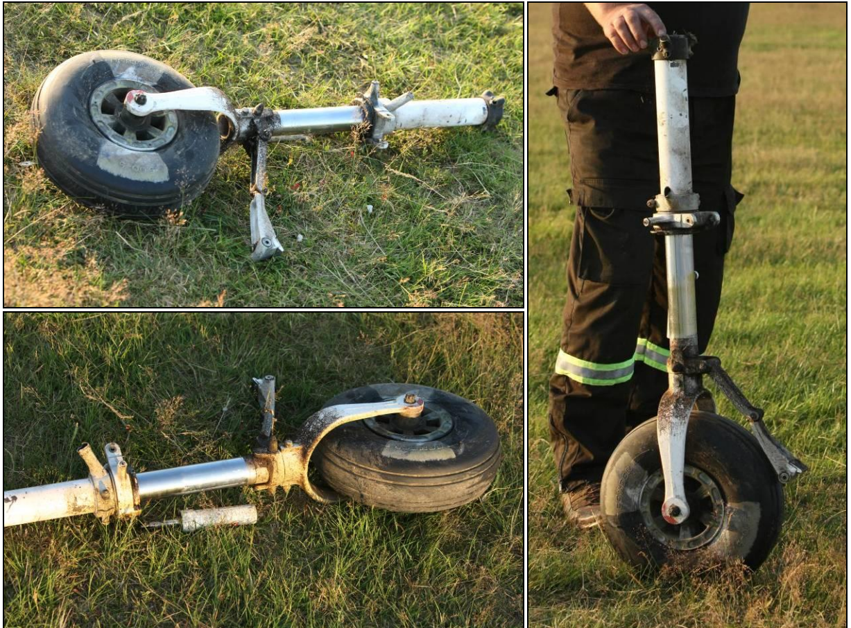
Rys.10,11,12 Oderwana od płatowca i uszkodzona przednia goleń podwozia (uszkodzenia elementów sterowania gołeni, nożyce, tłumik drgań)
