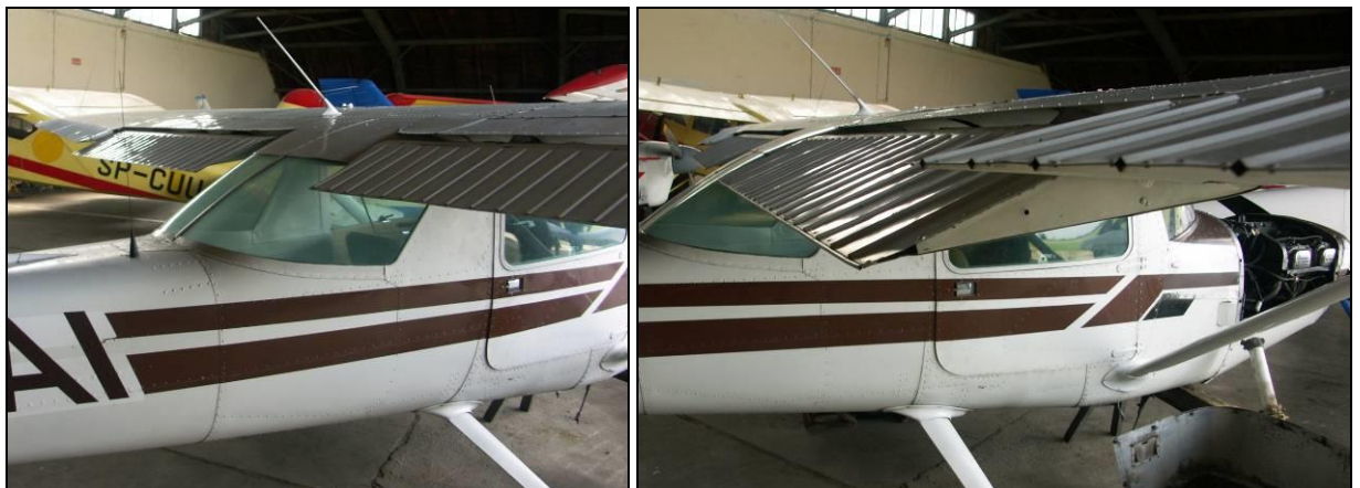
Rys.8,9 Samolot w hangarze – widoczne wychylenie kłap skrzydłowych
