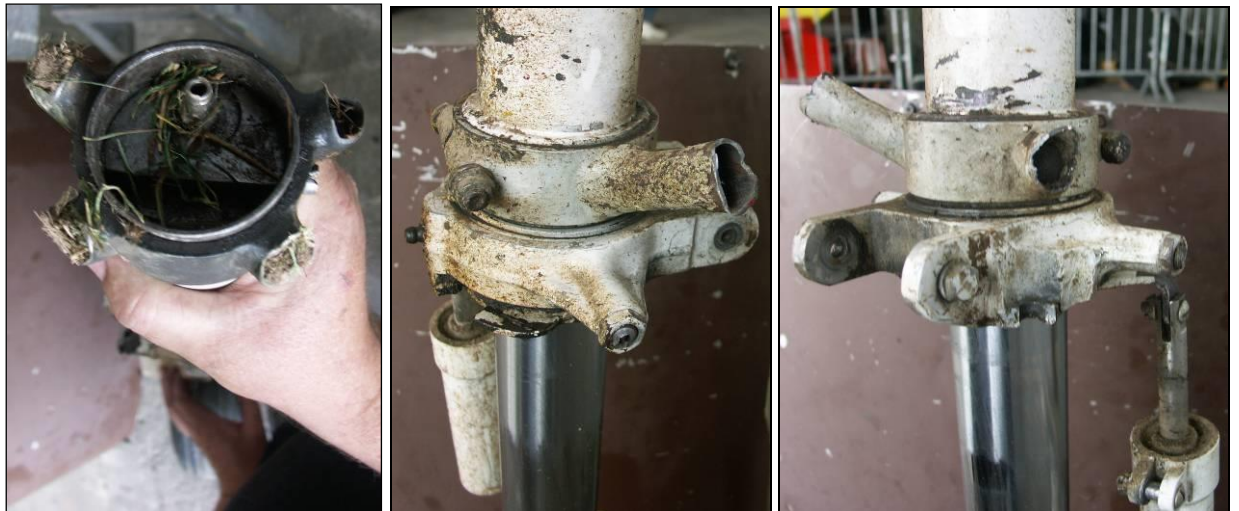
Rys.13,14,15 Zniszczony górny i dolny węzeł mocowania gołeni podwozia przedniego oraz mocowania elementów sterowania przednim kołem podwozia
