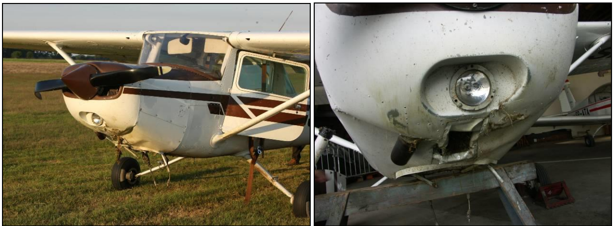
Rys.6,7 Widok uszkodzonego samolotu po uniesieniu kadłuba – po lewej na miejscu wypadku, po prawej w hangarze (widoczne uszkodzenia łopatek śmigła i dolnej osłony silnika, brak nogi przedniego podwozia)
