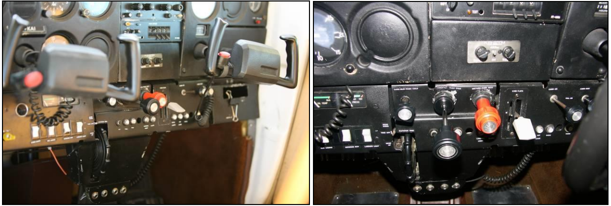
Rys.17,18 Widok tablicy przyrządów i sterowania z kabiny samolotu SP-KAI po wypadku (dźwignia sterowania przepustnicą – MAŁA MOC, dźwignia składu mieszanki – BOGATA, wskaźnik położenia trymera steru wysokości – DO STARTU, wskaźnik położenia klap skrzydłowych – niewiele powyżej 10°)
