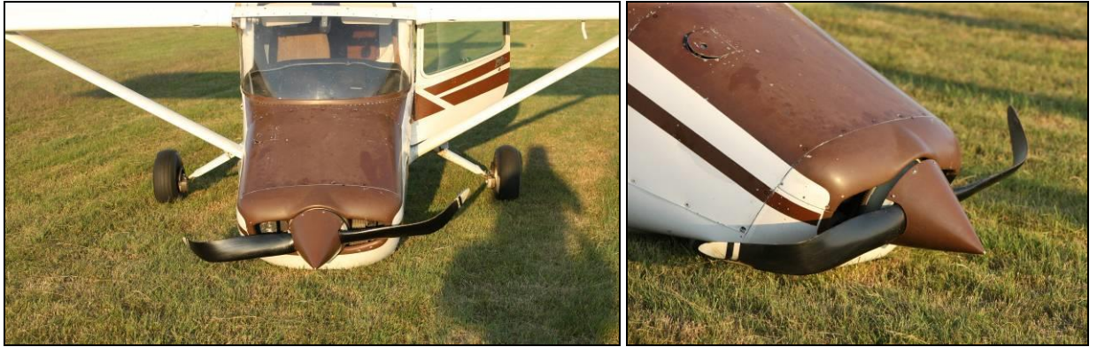
Rys.4,5 Samolot na miejscu wypadku – widok od przodu i z prawej strony przed uniesieniem kadłuba (widoczne uszkodzenia łopatek śmigła)
