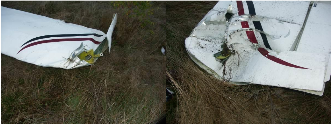
Rys. 7 Uszkodzenia końcówek lewego i prawego skrzydła.
