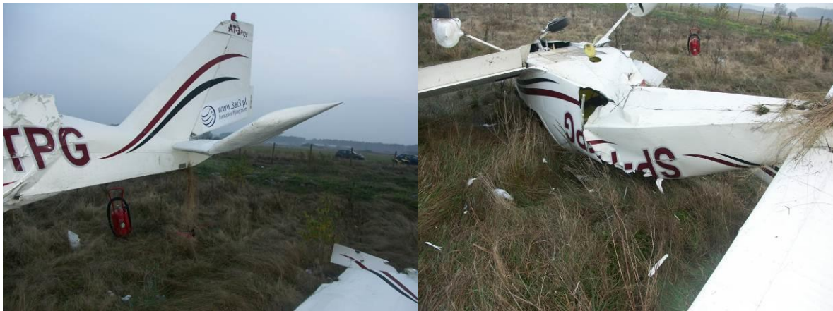
Rys. 8 Zgięcie usterzenia poziomego i skręcenie kadłuba.
