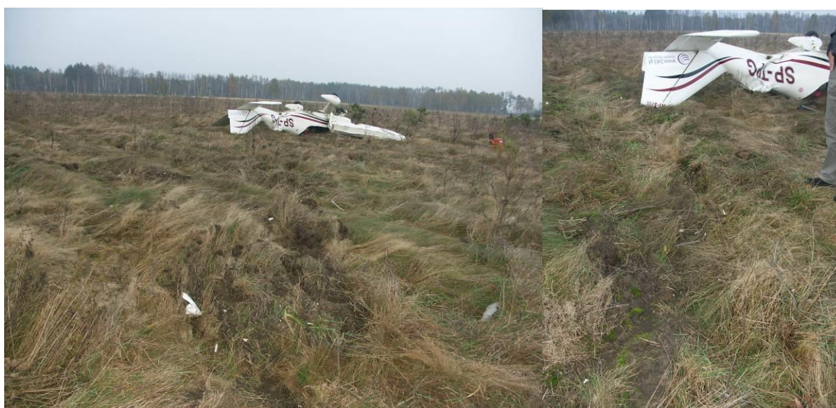
Rys. 6 Ślady uderzenia przodem i skrzydłem samolotu.
