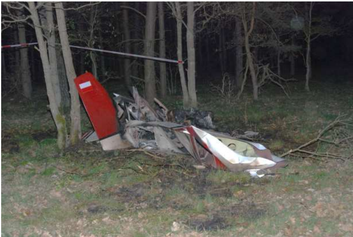
Fot. 5 Widoczne ślady pożaru w obrębie wraku, z przodu, z tyłu i po prawej stronie samolotu. Wskazuje to na znaczną pozostałość paliwa w zbiornikach skrzydłowych w momencie zderzenia z ziemią.
