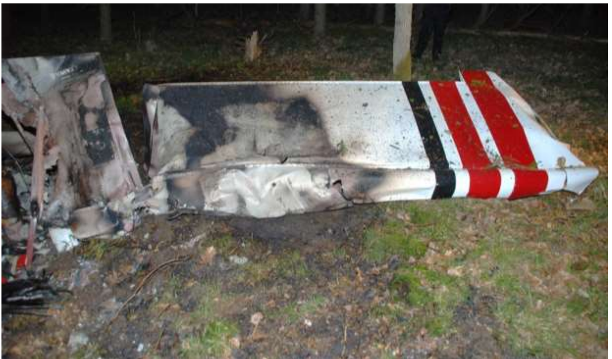
Fot. 4 Widoczne ślady pożaru po rozszczelnieniu zbiorników skrzydłowych w wyniku zderzenia z ziemią.
