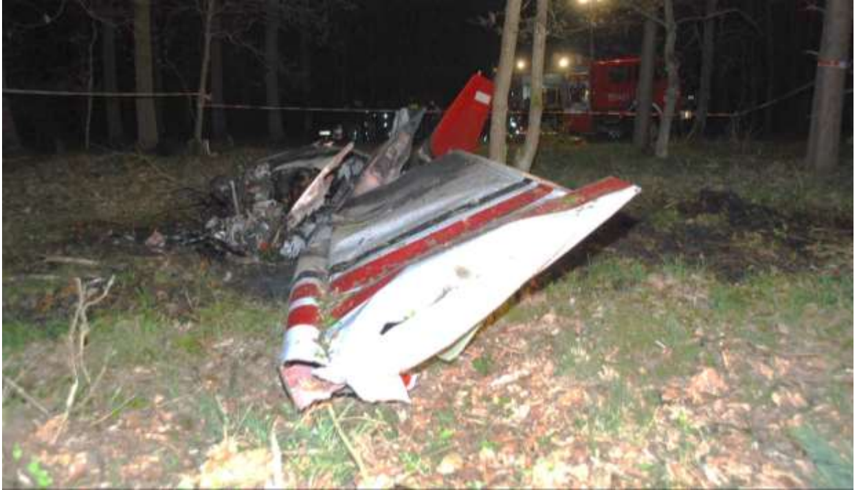
Fot. 3 Widok z boku na wrak samolotu. Charakterystyczne równomierne odkształcenie przedniej części skrzydła (spęczenie) na całej rozpiętości świadczy o pionowym zderzeniu samolotu z ziemią. Zwraca uwagę całkowite zniszczenie kadłuba przed skrzydłami oraz ślady pożaru przed i za wrakiem samolotu.
