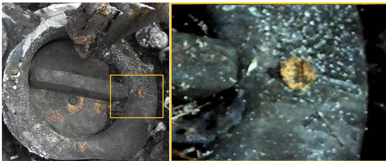
Rys. 5. Stan trójdrogowego zaworu paliwowego na miejscu wypadku - „L” – lewy zbiornik otwarty.
