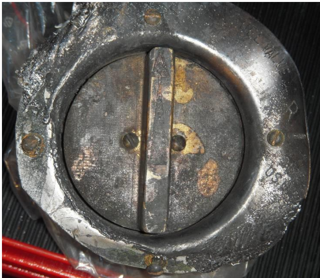
Rys. 8 i 9. Trójdrogowy zawór paliwowy po demontażu z wraku i oczyszczeniu – przygotowany do oględzin i badań w warunkach warsztatowych.
