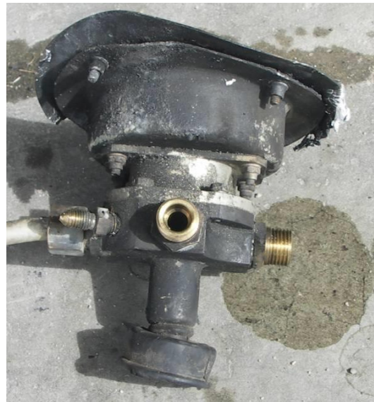
Rys. 8 i 9. Trójdrogowy zawór paliwowy po demontażu z wraku i oczyszczeniu – przygotowany do oględzin i badań w warunkach warsztatowych.
