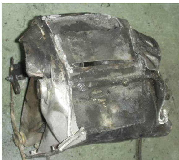
Rys. 13 i 14. Stan zespołu podgrzewania powietrza po wypadku. Po prawej uszkodzona płytki sterująca dopływem powietrza do gaźnika.
