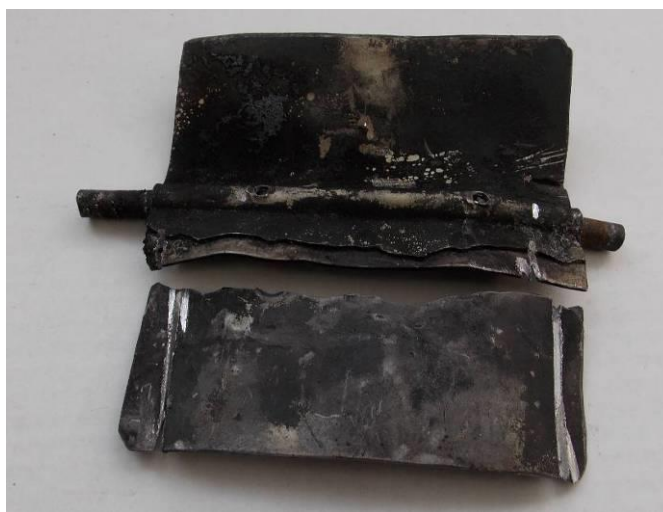
Rys. 13 i 14. Stan zespołu podgrzewania powietrza po wypadku. Po prawej uszkodzona płytki sterująca dopływem powietrza do gaźnika.
