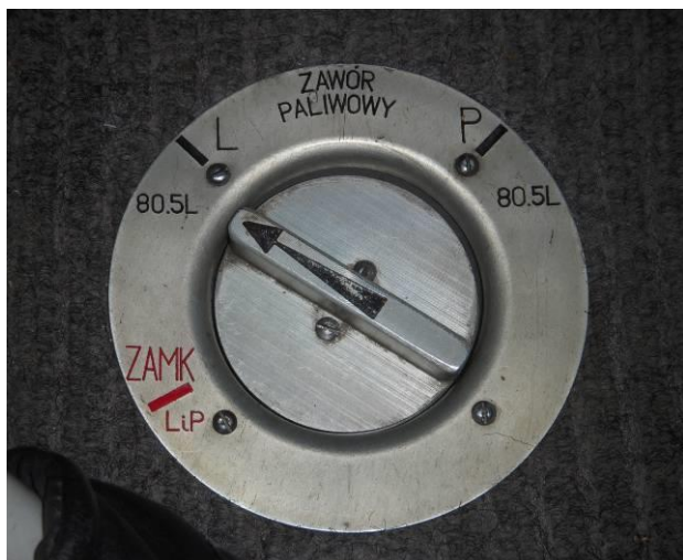
Rys. 10. Odtworzone na bliźniaczym samolocie PZL-150A Koliber, SP-FRU, położenie pokrętła trójdrogowego zaworu paliwowego częściowo zamkniętego (nieznacznie odchylonego od pozycji „L” – lewy zbiornik otwarty) w celu wykonania próby naziemnej.
