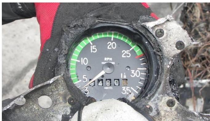
Rys. 7. Zniszczony pożarem fragment tablicy przyrządów z uszkodzonym obrotomierzem.
