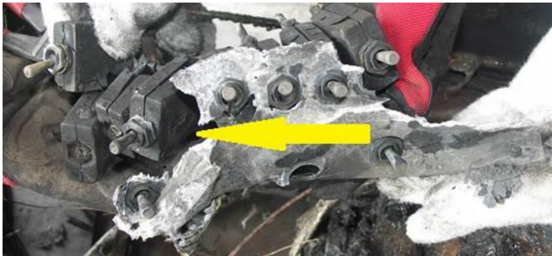
Rys. 11. Fragment zniszczonej tablicy przyrządów pokładowych. Strzałką zaznaczono wyłącznik automatyczny elektrycznej wspomagającej pompy paliwa.
