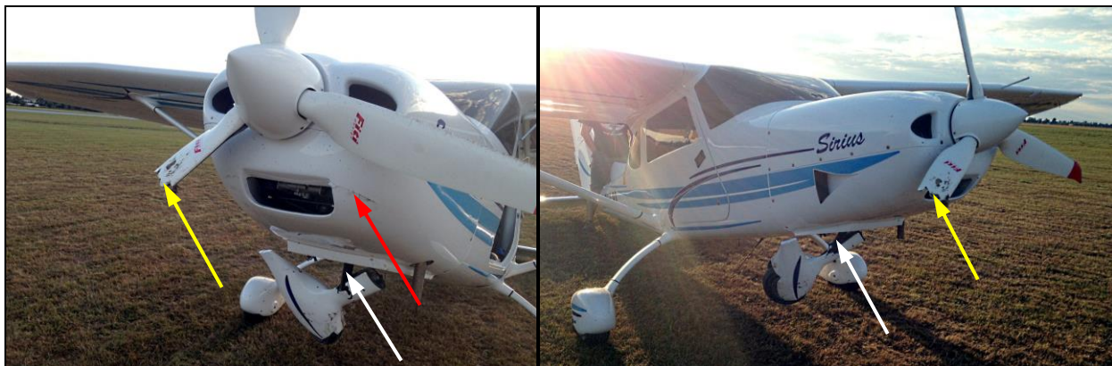
1, 2 – Samolot po zdarzeniu. Widoczne uszkodzenie dolnej osłony silnika (strzałka czerwona), zniszczona łopata śmigła (strzałka żółta) i złamana goleń podwozia przedniego (strzałka biała) [zdjęcia: Użytkownik samolotu].
