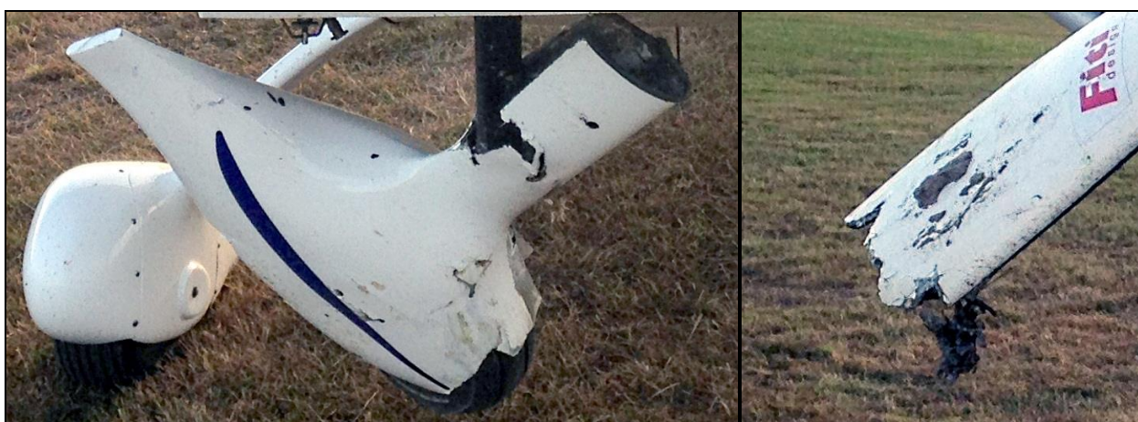
3, 4 – Odłamana część podwozia przedniego i zniszczona łopata śmigła w zbliżeniu [zdjęcia: Użytkownik samolotu].
