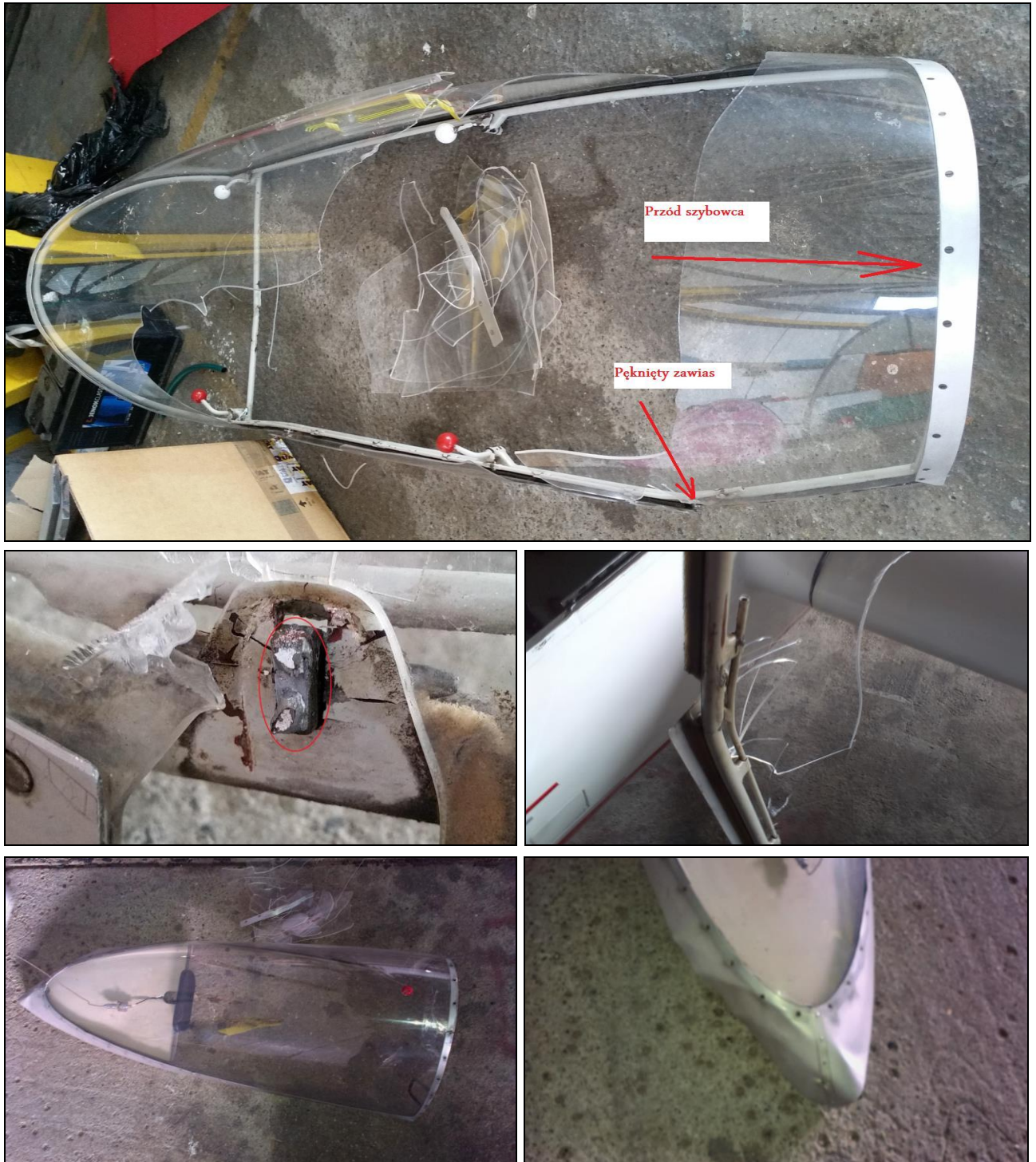
Rys.1÷5 Uszkodzenia zawiasu oraz osłon szybowca SZD-9bis Bocian 1E (fot. Aeroklub Warszawski)
