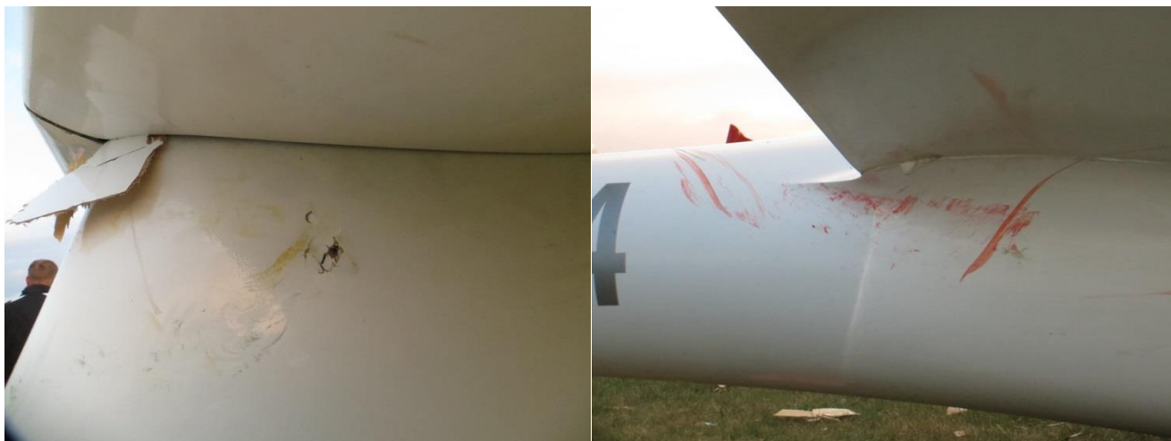
fot. 5 i 6 Uszkodzenia szybowca Puchacz (wszystkie zdjęcia przesłanie przez Aeroklub Nadwiślański)
