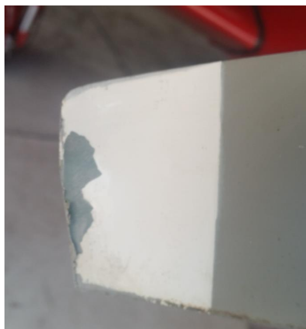
Rys. 3. Uszkodzona końcówka jednej z łopat śmigła [foto Użytkownik]
