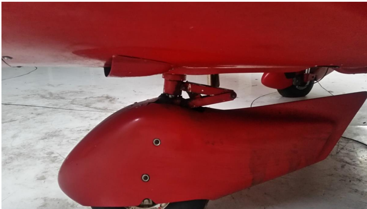
Rys. 1. Uszkodzony amortyzator przedniej goleni [foto Użytkownik]
