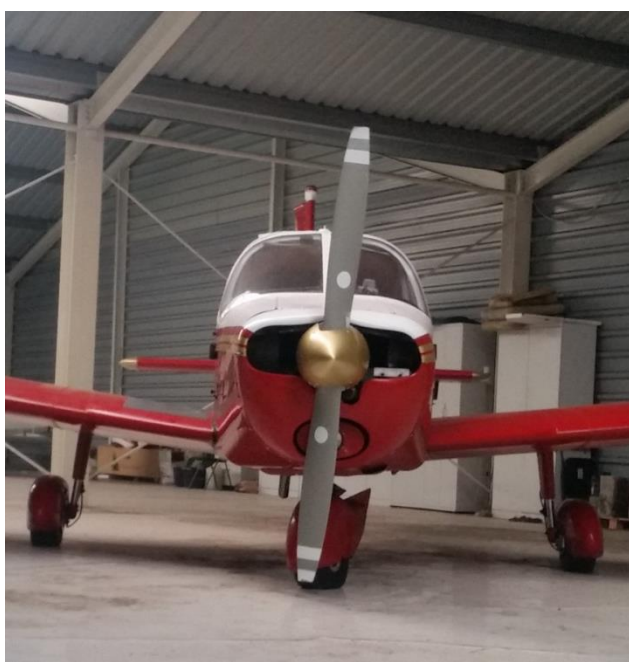
Rys. 2. Zdjęcie samolotu od czola, widoczny zmniejszony prześwit śmigła [foto Użytkownik]
