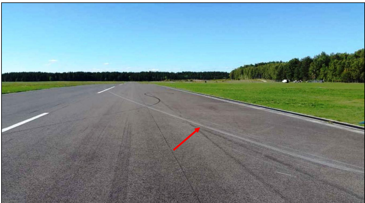
Ilustracja 1. Ślad pozostawiony przez samolot na pasie 09 (czerwona strzałka); widok w kierunku progu pasa.
