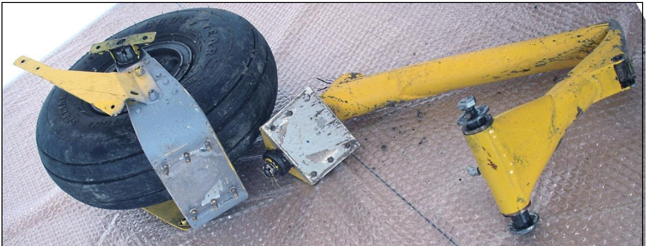
5 – Zniszczone przednie podwozie – widok ogólny.
