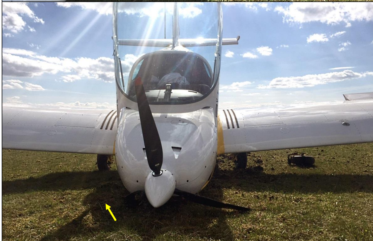
3, 4 – Przednia część samolotu. Widoczne uszkodzenia dolnej osłony silnika (strzałka czerwona) i złamana łopata śmigła (strzałki żółte).
