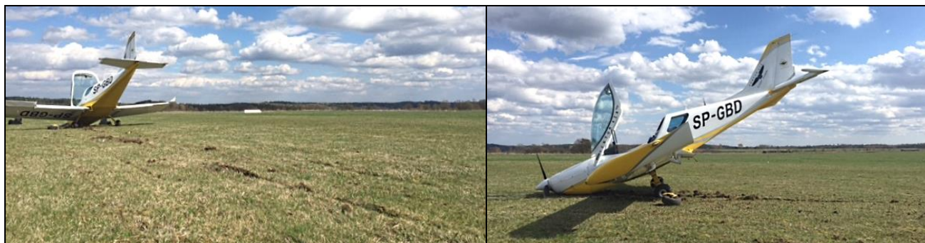
1, 2 – Samolot po wylądowaniu. Widoczny ślad złamanej nogi podwozia przedniego i odłamany widelec z kołem przednim.
