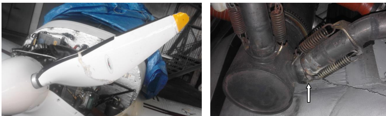
Rys. 2. Uszkodzenia śmigła, po lewej oraz uszkodzenia układu wydechowego, po prawej.
