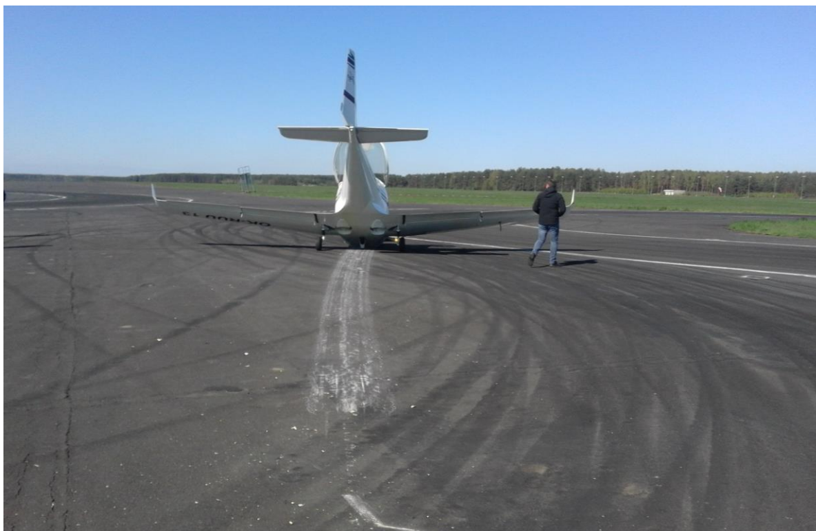
Rys. 1. Samolot po zakończonym dobiegu. Widoczny ślad kontaktu dolnej maski silnika z nawierzchnią asfaltową DS-1.
