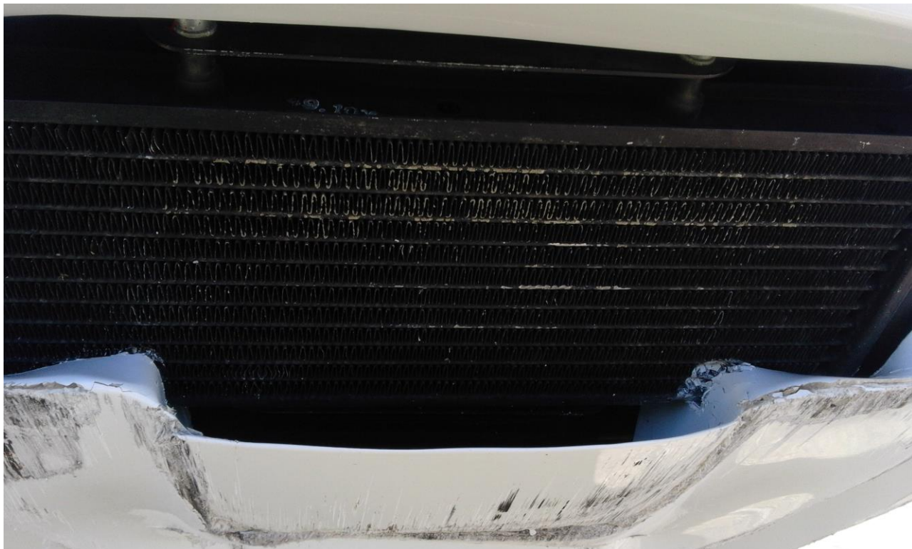
Rys. 3. Uszkodzona chłodnica płynu chłodzącego
