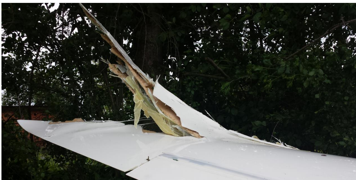
Ilustracja nr 3. Uszkodzona końcówka lewego skrzydła.
