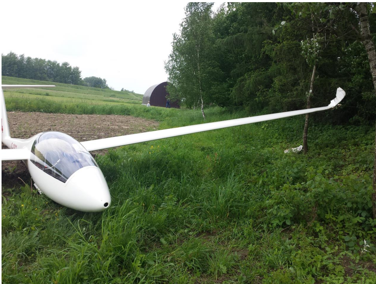
Ilustracja nr 2. Położenie szybowca po zakończonym dobiegu. Widoczne drzewo o które zahaczyła końcówka lewego skrzydła.
