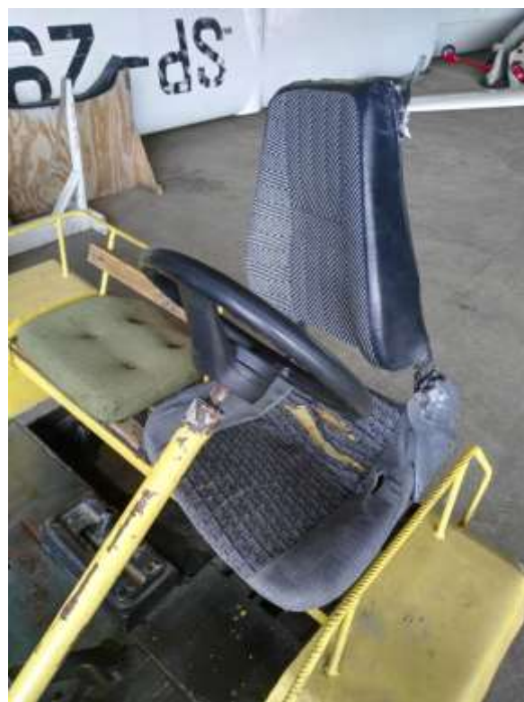
Fot.2 Uszkodzenia ściągarki (traktorek ściągający szybowce)
