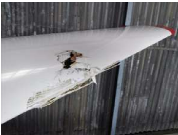
Fot.1 Uszkodzenia skrzydła szybowca
