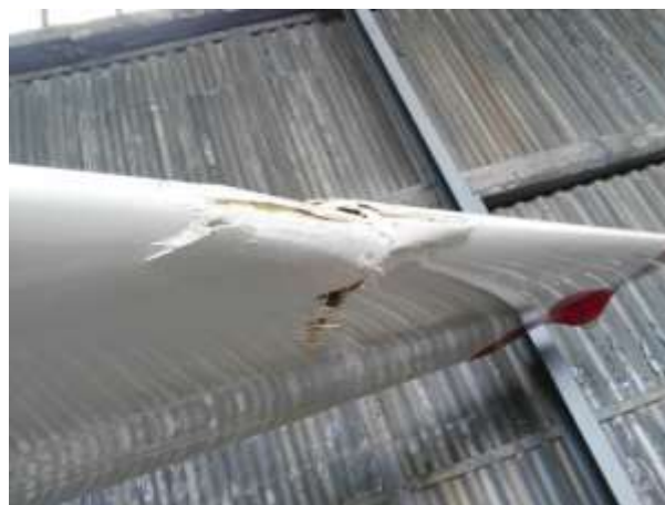
Fot.1 Uszkodzenia skrzydła szybowca
