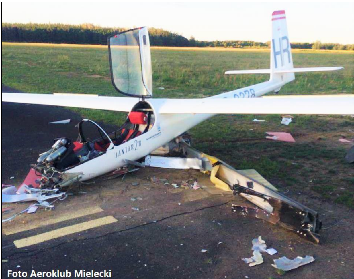
Ilustracja nr 3. Uszkodzenia szybowca. Widoczne fragmenty zniszczonej tablicy świetlnej oznaczającej drogę kołowania
