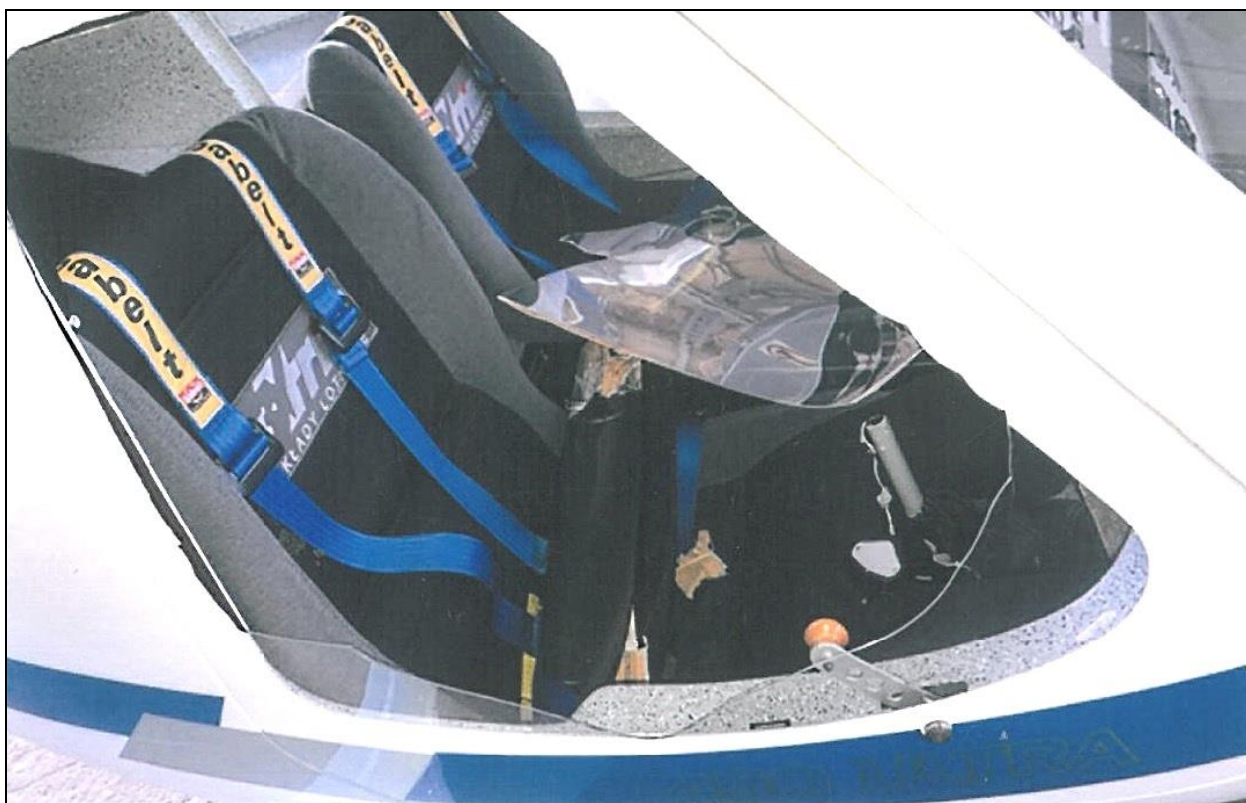
4 – Zniszczone oszklenie prawych drzwi.
