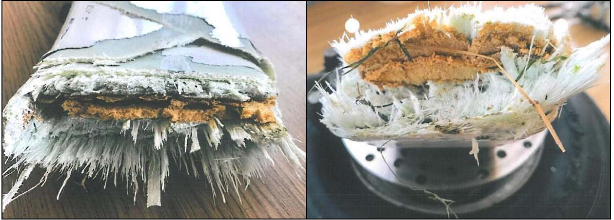
5, 6 – Przełom prawej nogi podwozia głównego.
