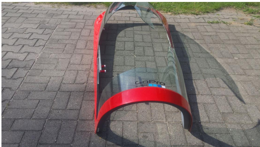
Rys. 1 Owiewka kabiny po zdemontowaniu z samolotu Extra EA 300/L [źródło: Użytkownik]
