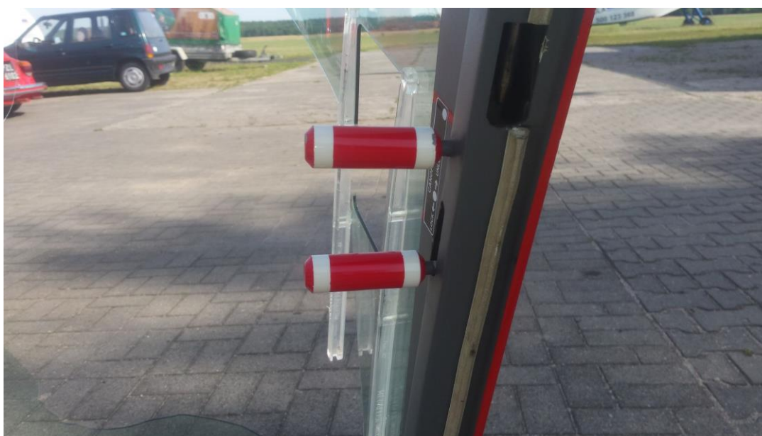
Rys. 2 Widok szczegółowy zamka zabezpieczającego owiewkę kabiny [źródło: Użytkownik]
