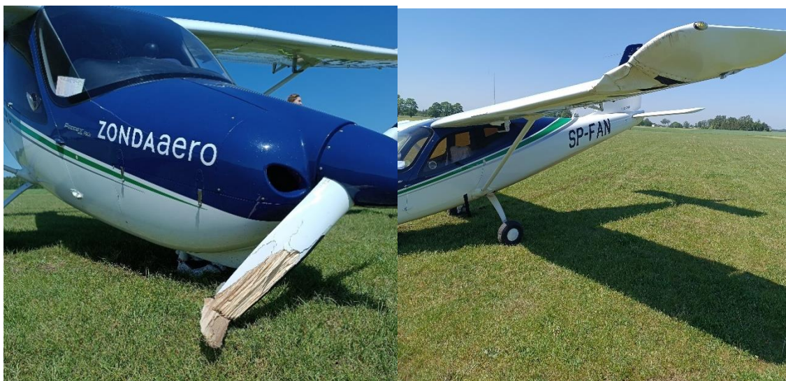
Rys.9 Widok uszkodzonego lewego skrzydła oraz łopaty śmigła
