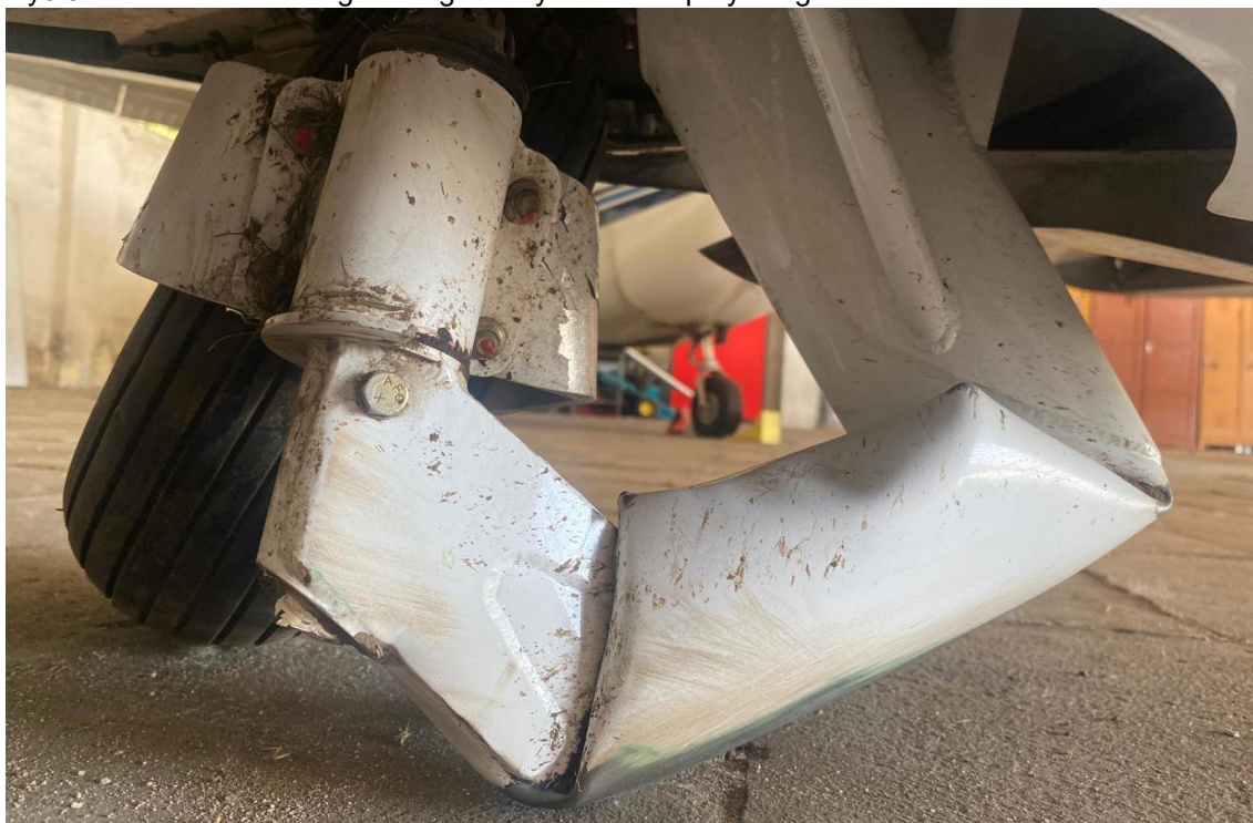
Rys.10 Pogięta przednia goleń podwozia
