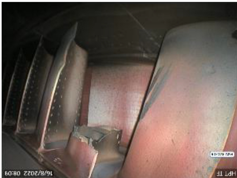
Rys. 2. Wyniki badania boroskopowego HPT. Silnik #2, łopatką HPT #80 złamana w ~15% długości, przy uszkodzeniach wielu łopatek HPT i osprzętu za nimi spowodowanych uwolnionymi szczątkami.
