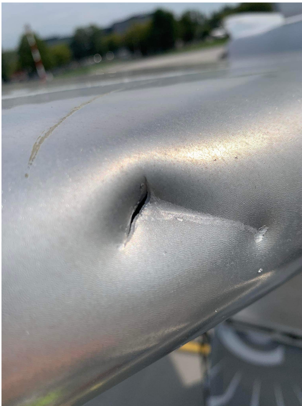
Rys. 6. Wgniecenie i pęknięcie krawędzi natarcia po prawej stronie statecznika poziomego.
