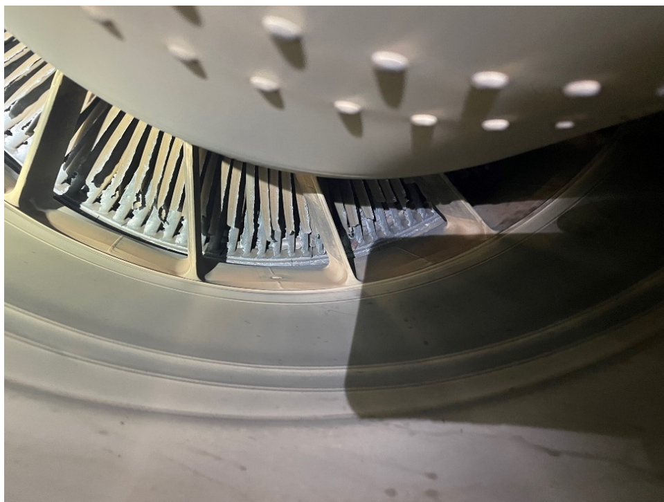
Rys. 3. Dwie fotografie uszkodzeń łopatek LPT stopnia 4 silnika #2 i osprzętu za nimi spowodowanych uwolnionymi szczątkami.
