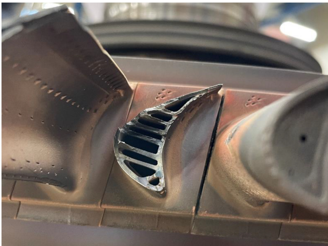
Rys. 18. Trzy fotografie. Fotografie przeglądowe na ekspozycji HPT. Łopatka #80. Liczne łopatki uległy uszkodzeniu w wyniku zderzenia z uwolnionymi szczątkami profilu.
