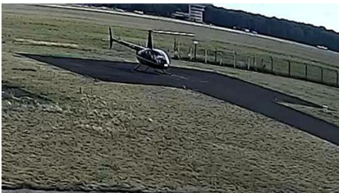
Rysunek nr 6. Początkowa próba startu, przemieszczenie linowe o około 1 m w prawo z jednoczesnym obrotem o około 30^\circ w lewo z pochyleniem do przodu [źródło: zapis z kamery przemysłowej].
