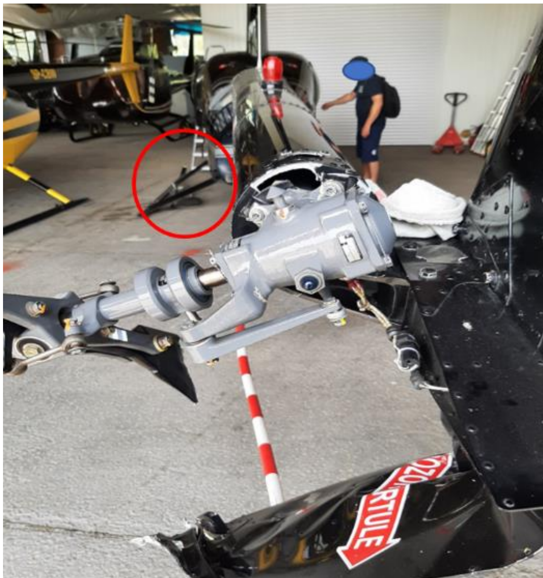
Rysunek nr 14. Wyłamana przekładnia kątowa wraz z mocowaniem do zespołu belki ogonowej, uszkodzone podwozie płożowe (czerwone kółko lewa płoza).
