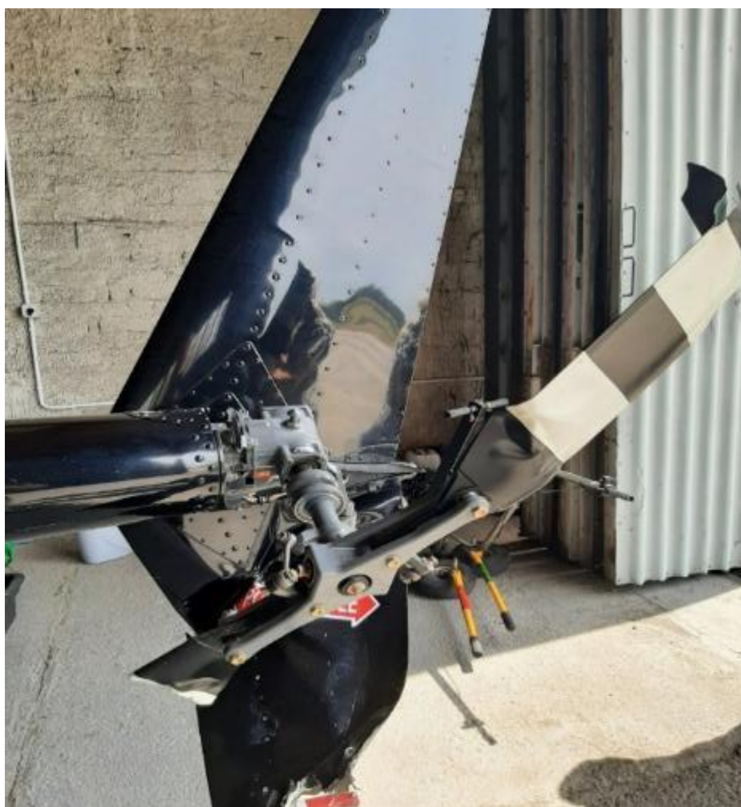
Rysunek nr 12. Zniszczone śmigło ogonowe, uszkodzone mocowanie przekładni kątowej do belki ogonowej.
