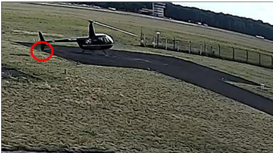
Rysunek nr 9. Po kolejnym obrocie o około 90^\circ z pierwszym uderzeniem płozą ogonową o płytę helipadu (oznaczone czerwonym kółkiem) [źródło: zapis z kamery przemysłowej].
