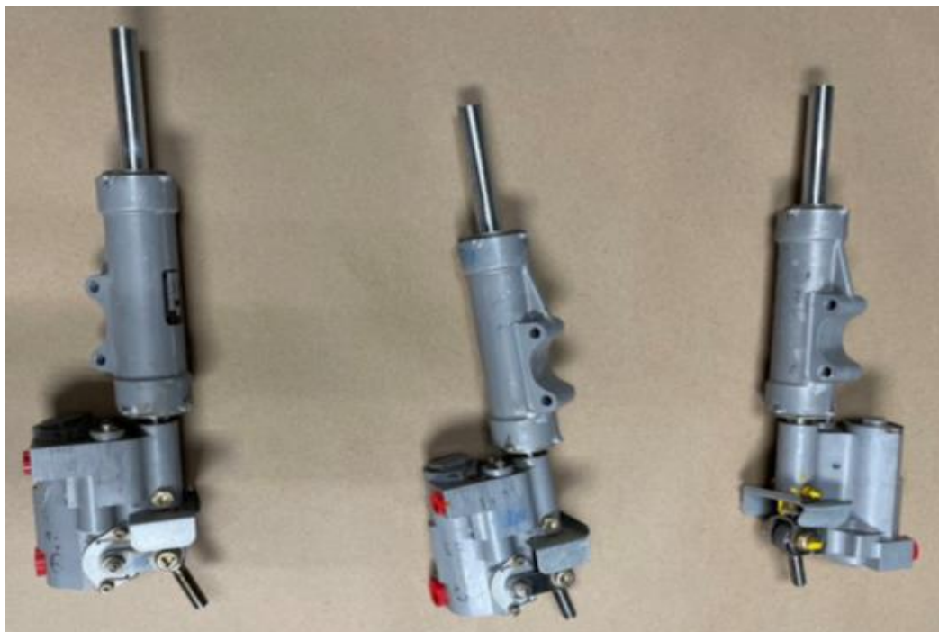
Rysunek nr 4. Wzmacniacze hydrauliczne zdemontowane ze śmigłowca [źródło: NTSB].
