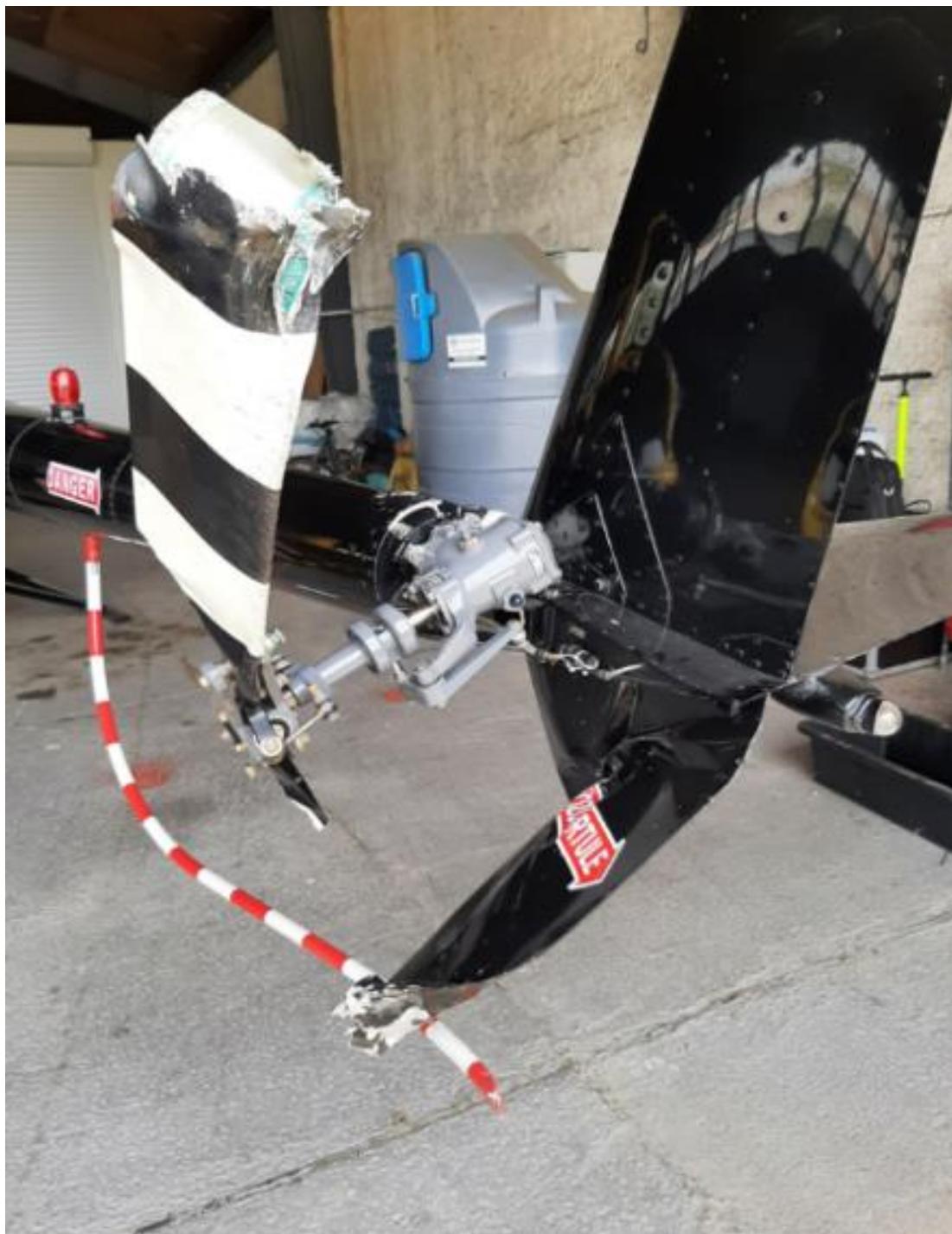
Rysunek nr 13. Wyłamana płoza ogonowa, zniszczony dolny statecznik pionowy oraz złamana obejmą śmigła ogonowego.
