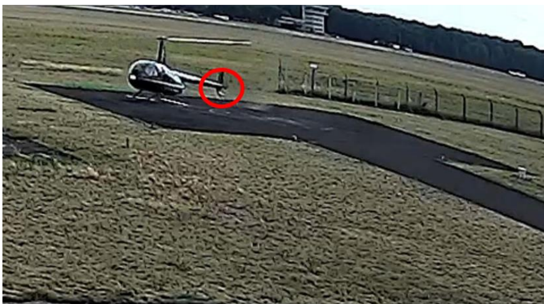
Rysunek nr 10. Po kolejnym obrocie o około 270^\circ , drugie uderzenie płozą ogonową o płytę helipadu (oznaczone czerwonym kółkiem) [źródło: zapis z kamery przemysłowej].
