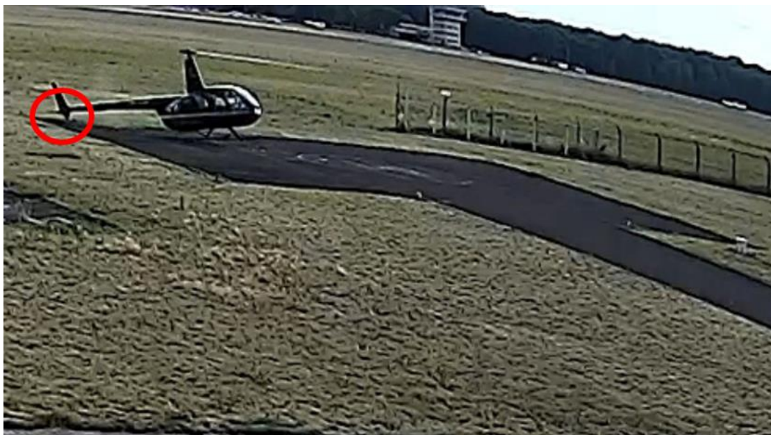
Rysunek nr 11. Chwilę przed zatrzymaniem obrotów w lewo, trzecie uderzenie o płytę helipadu, zniszczenie śmigła ogonowego (oznaczone czerwonym kółkiem) [źródło: zapis z kamery przemysłowej].
