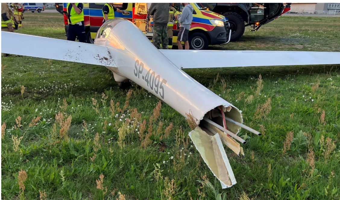
Rysunek 3. Uszkodzony szybowiec Grob G 103, po zdarzeniu [źródło: Polska Fundacja Lotnicza]
